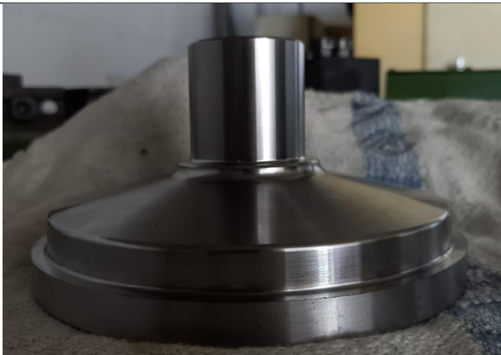
Slika 36. Potokaren poklopac spojke
