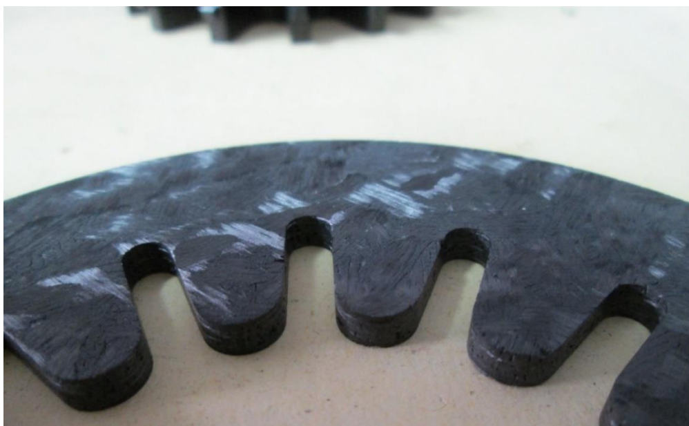
Slika 59. Vizualna kontrola obrađene površine
