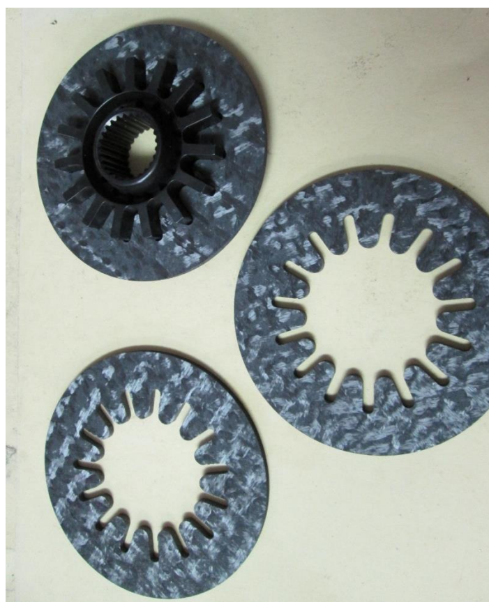
Slika 58. Proba unutarnje lamele s jezgrom spojke
