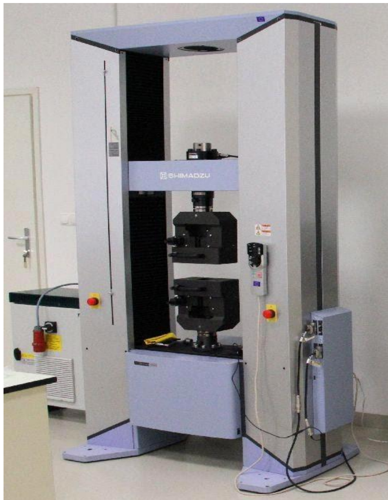
Slika 17. Kidalica Shimadzu AG-X [25]
