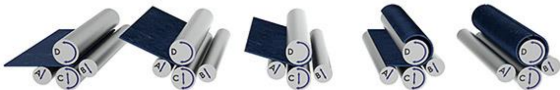
Slika 8: Prikaz rada na savijačici s 4 valjka [15]
