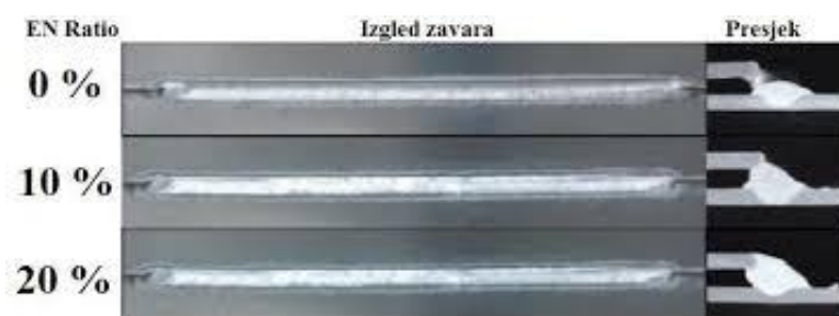
Slika 28. Utjecaj negativnog polariteta pri spajanju aluminijske legure [18]
