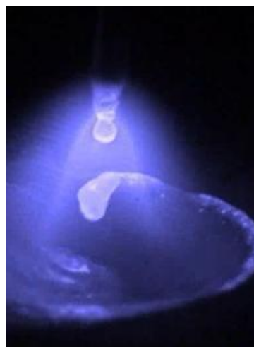
Slika 10. Realni prikaz metala štrcajućim lukom [12]
