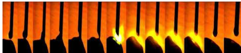
Slika 25. Odvajanje kaplice električnim lukom kod FastROOT postupka [24]
