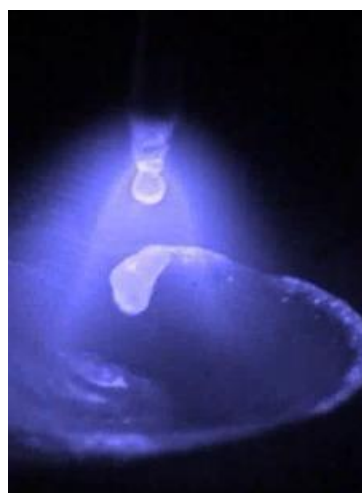
Slika 10. Realni prikaz metala štrcajućim lukom [12]
