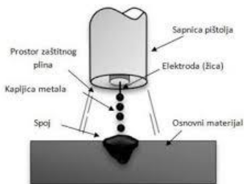
Slika 9. Shema prijenosa metala [12]
