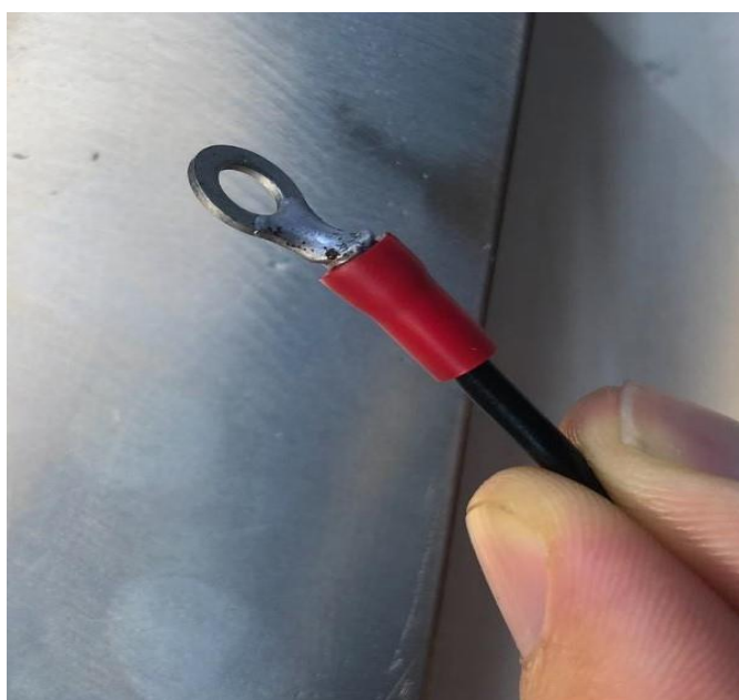
Slika 22. Korištena stopica (okasta) u svrhu uzemljenja kućišta
