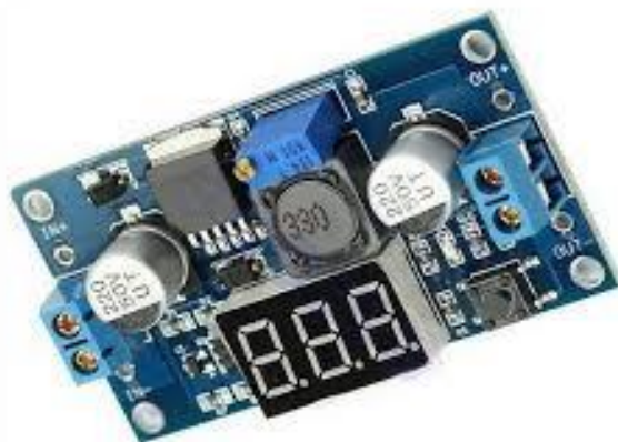
Slika 8. Modul regulatora napona sa LCD prikazom
