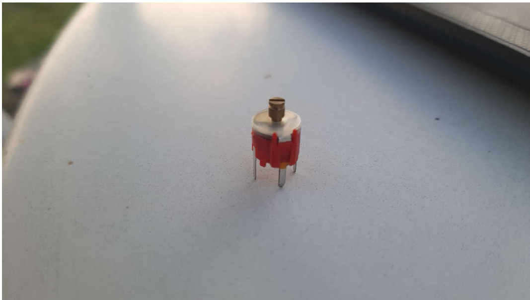
Slika 7. 30pF varijabilni trimmer kondenzator
