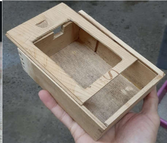
Slika 31. Kućište s kliznim poklopcem
