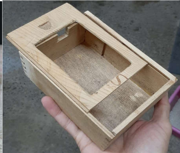
Slika 31. Kućište s kliznim poklopcem
