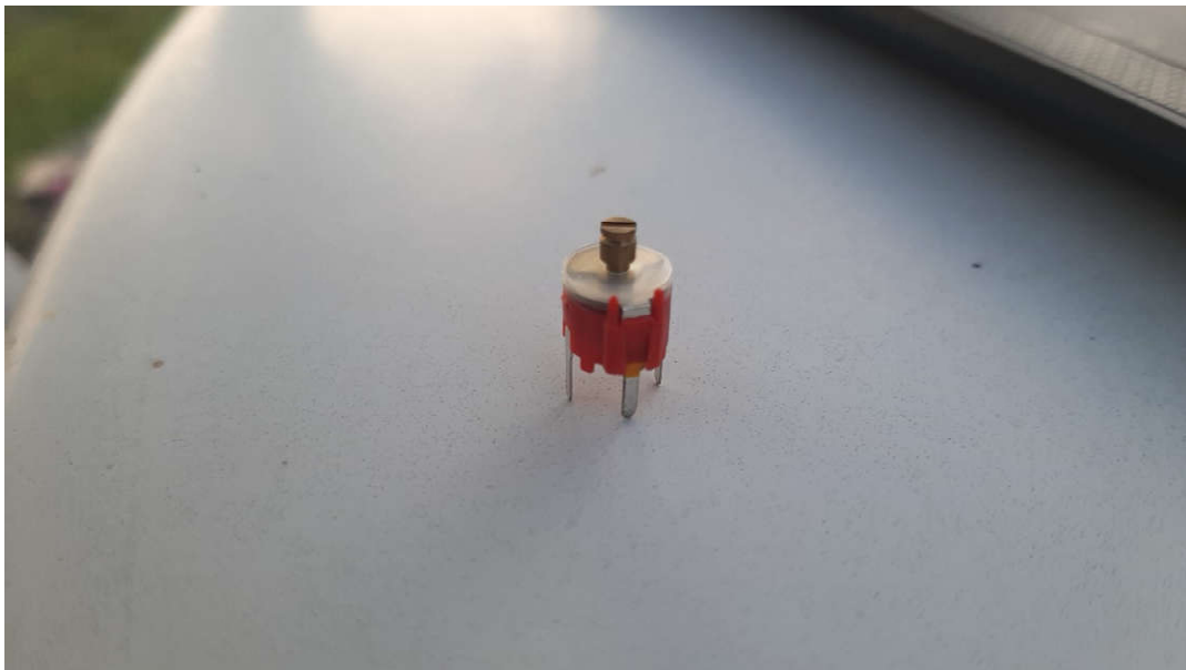
Slika 7. 30pF varijabilni trimmer kondenzator
