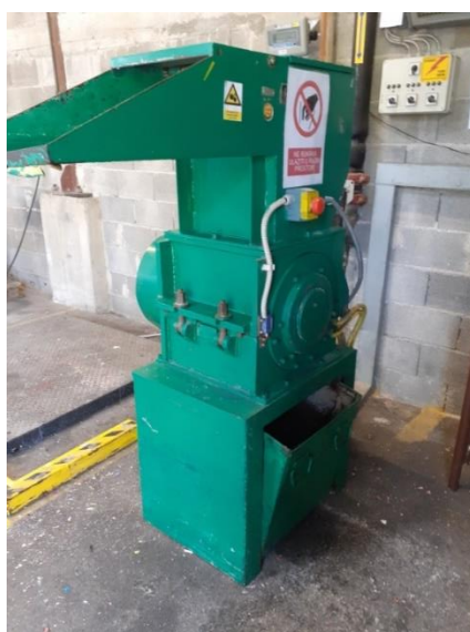
Slika 47. Mlin za usitnjavanje polimernih masa MG – 200
