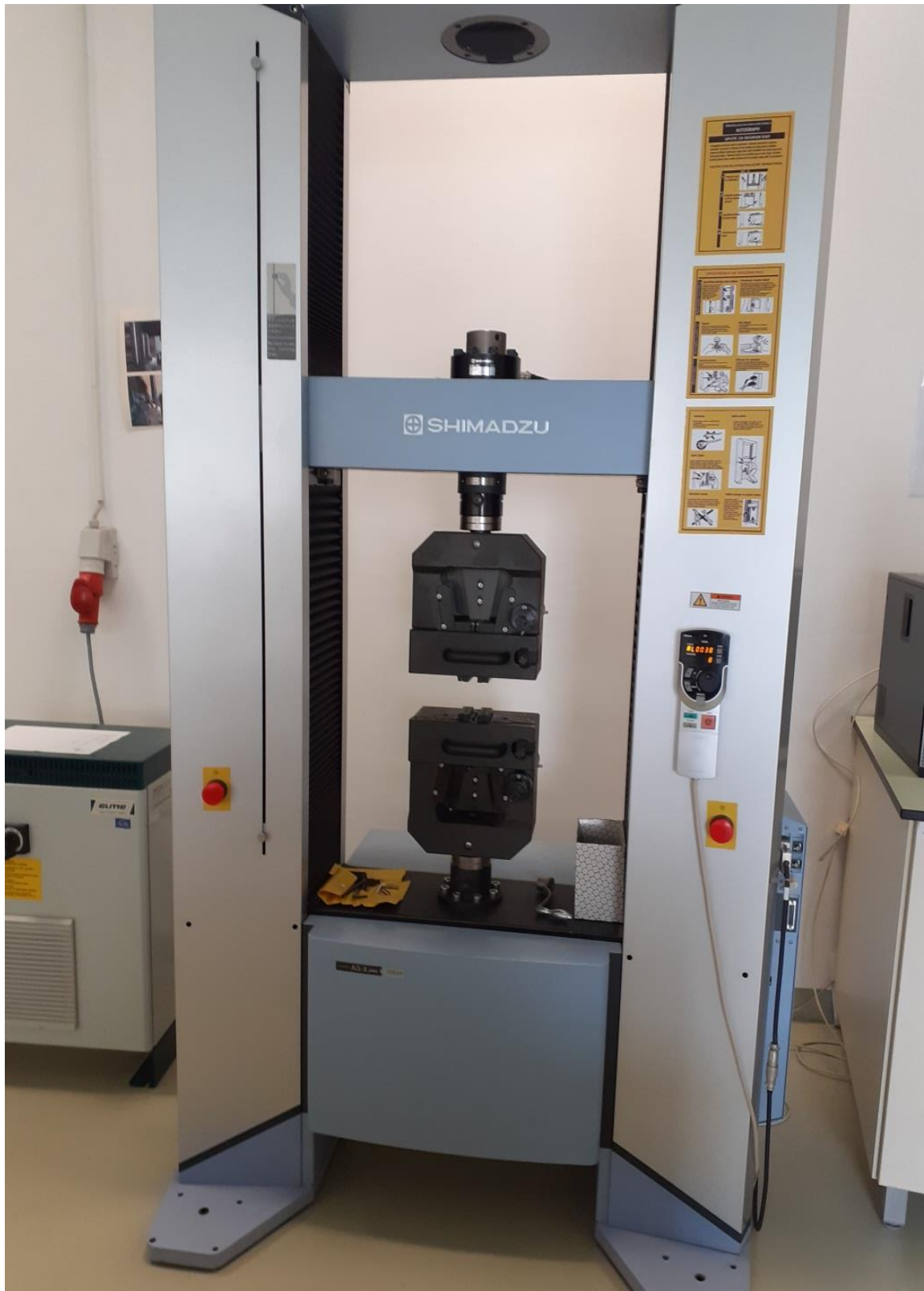
Slika 49. Kidalica Schimadzu AG – X plus
