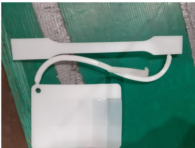
Slika 34. Epruveta – ispitni uzorak polipropilena
