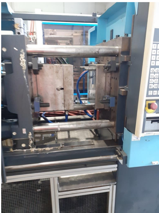
Slika 46. Injekcijska preša DEMAG ERGOtech 80 – 200 NC 4
