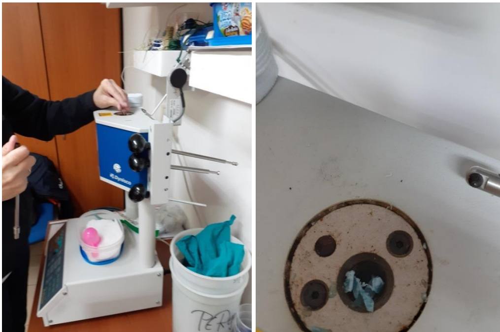
Slika 41. Utiskivanje polimera u otvor uređaja za mjerenje MFR-a
