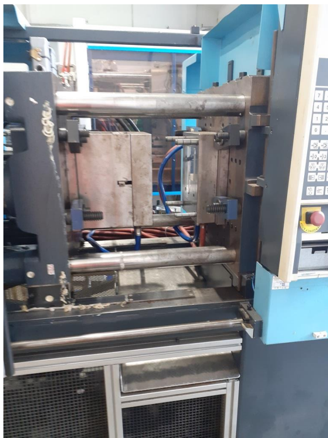
Slika 46. Injekcijska preša DEMAG ERGOtech 80 – 200 NC 4
