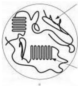
Slika 15. Makromolekularna struktura kristalastih plastomera [21]
