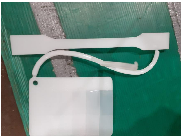
Slika 34. Epruveta – ispitni uzorak polipropilena
