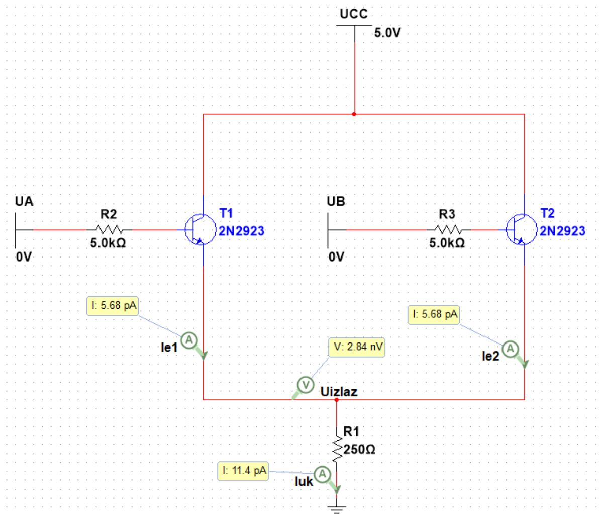
Slika 35. Shema logičke operacije ILI s bipolarnim tranzistorom (1).
