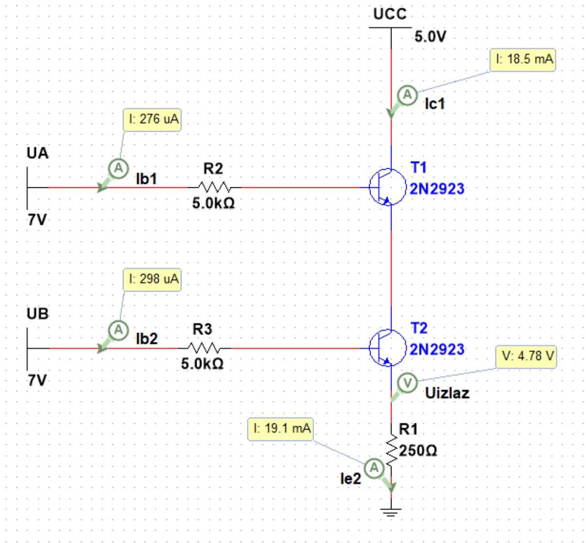
Slika 30. Shema logičke operacije I s bipolarnim tranzistorom (4) .
