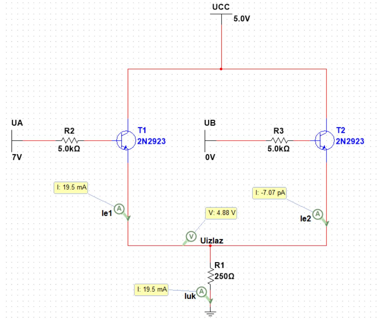
**Slika 36.** Shema logičke operacije ILI s bipolarnim tranzistorom (2) .
