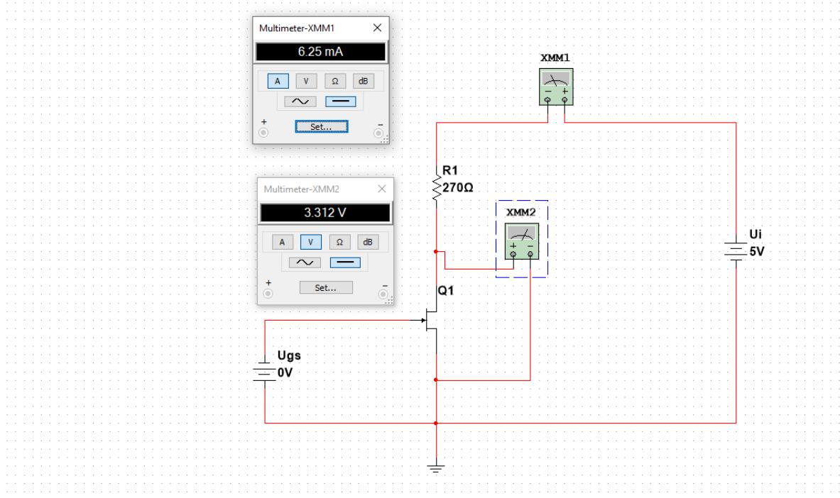
Slika 19. Predodžba N-kanalnog JFET-a kao zatvorene sklopke.
