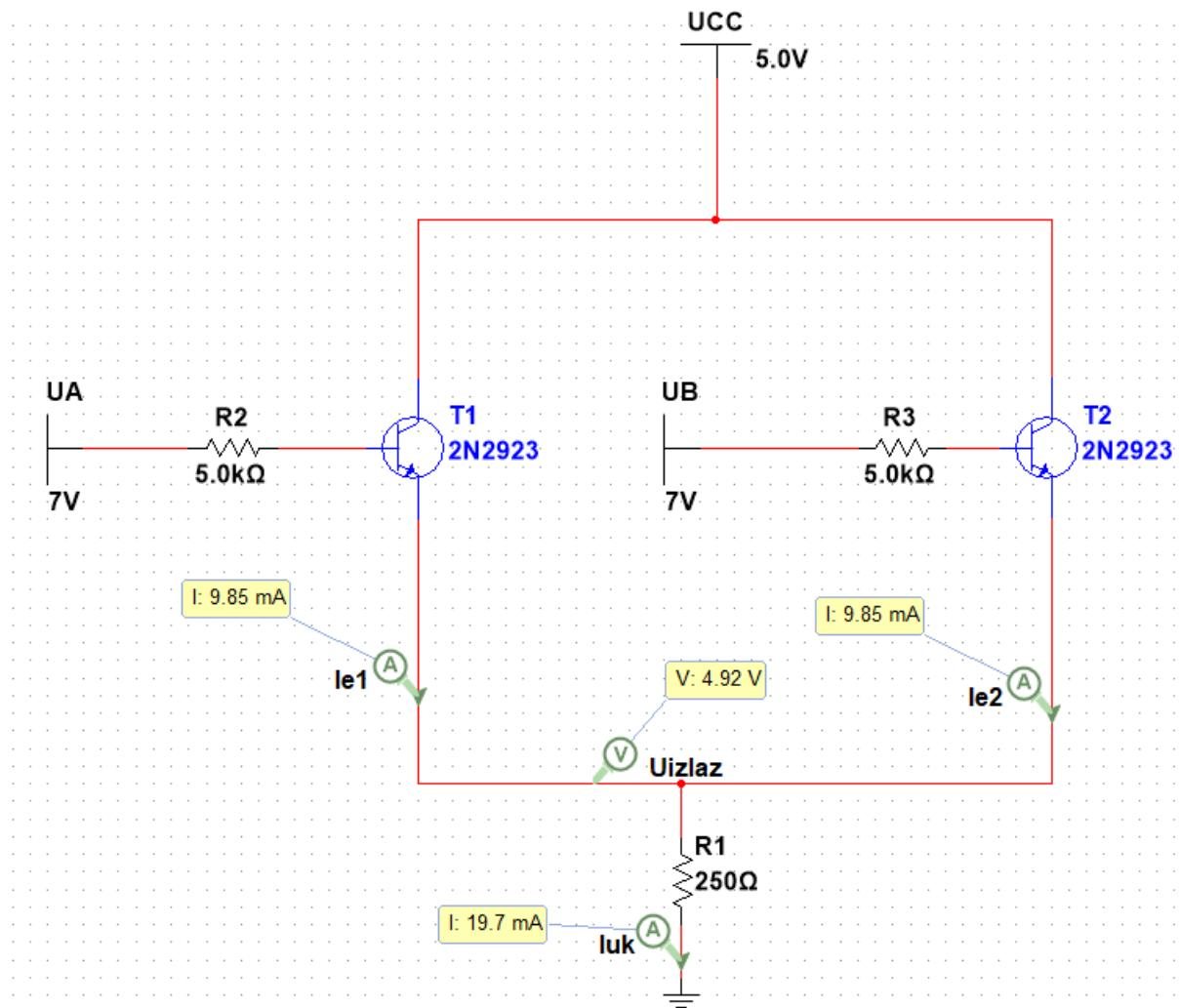
**Slika 38.** Shema logičke operacije ILI s bipolarnim tranzistorom (4) .
