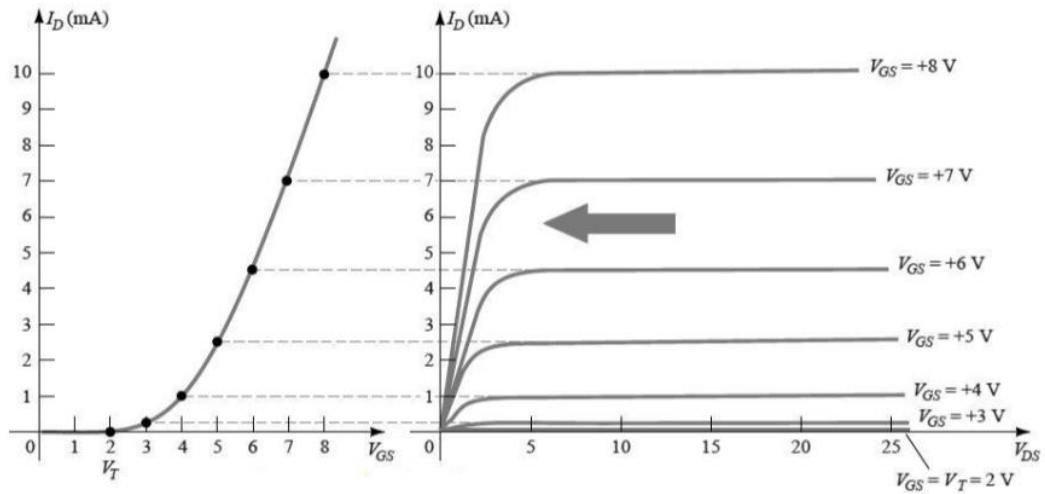
**Slika 21.** Predodžba grafa N-kanalnog obogaćenog MOSFET-a.
