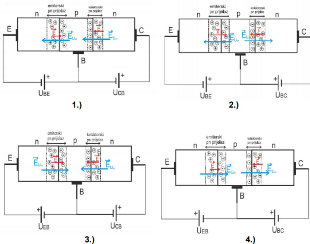
**Slika 14.** Predodžba sva 4 područja rada bipolarnog tranzistora.
