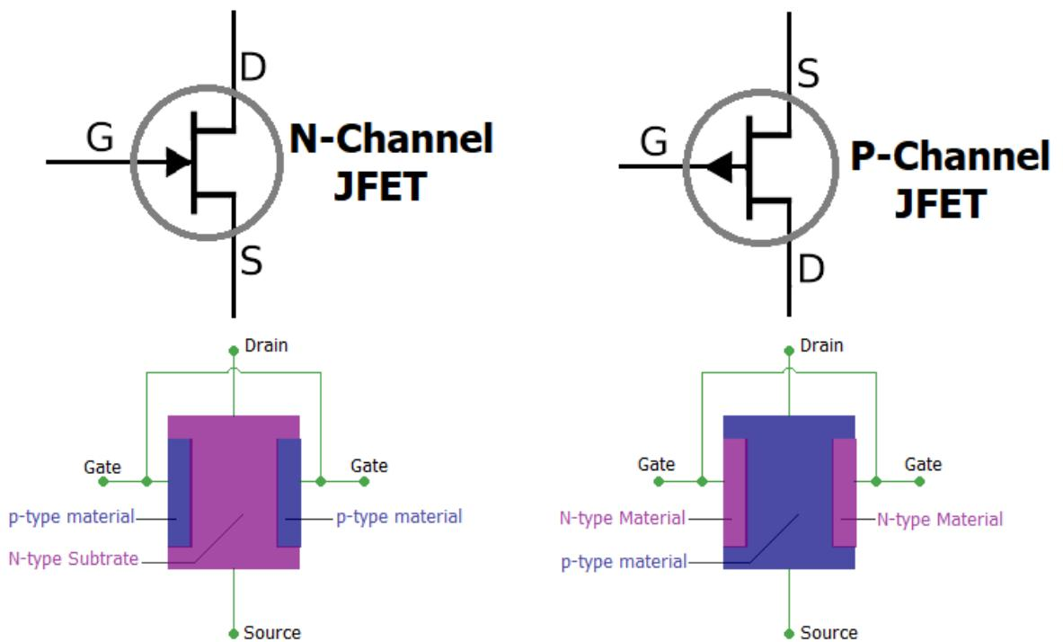
Slika 17. Predodžba N-kanalnog i P-kanalnog JFET-a.
