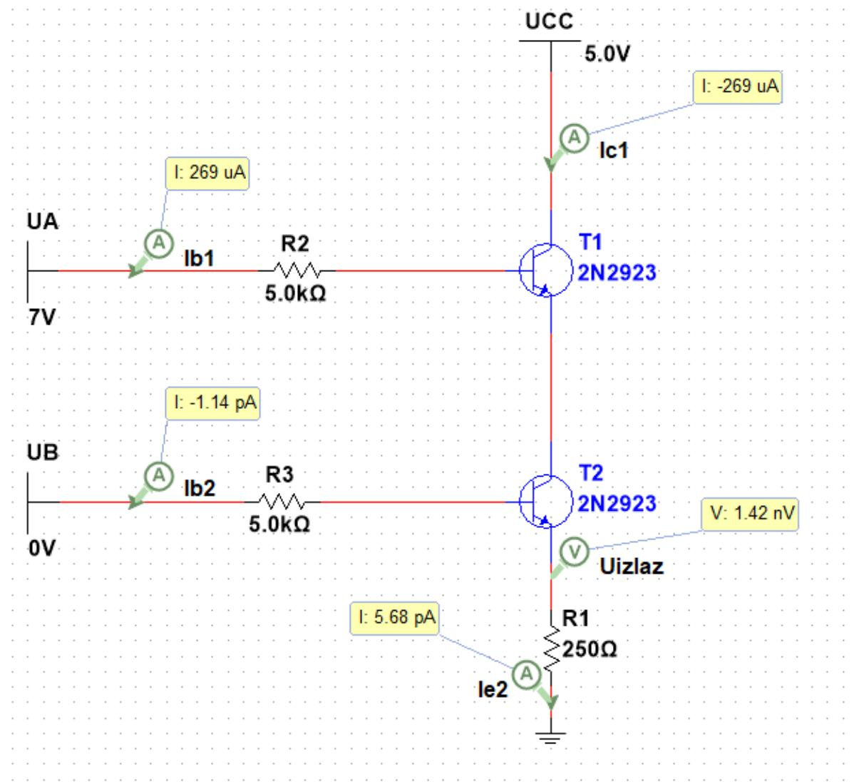
Slika 28. Shema logičke operacije I s bipolarnim tranzistorom (2) .
