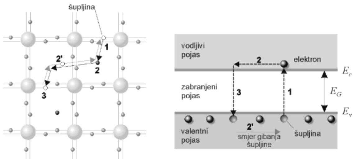
**Slika 6.** Predodžba toplinskog pobuđivanja i rekombinacije para elektron-šupljina u dvodimenzijonalnoj rešetci i energetskom dijagramu.
