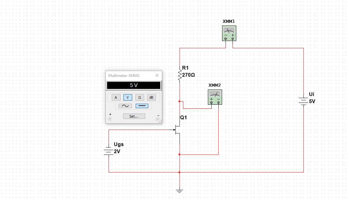
**Slika 20.** Predodžba N-kanalnog JFET-a kao otvorene sklopke.
