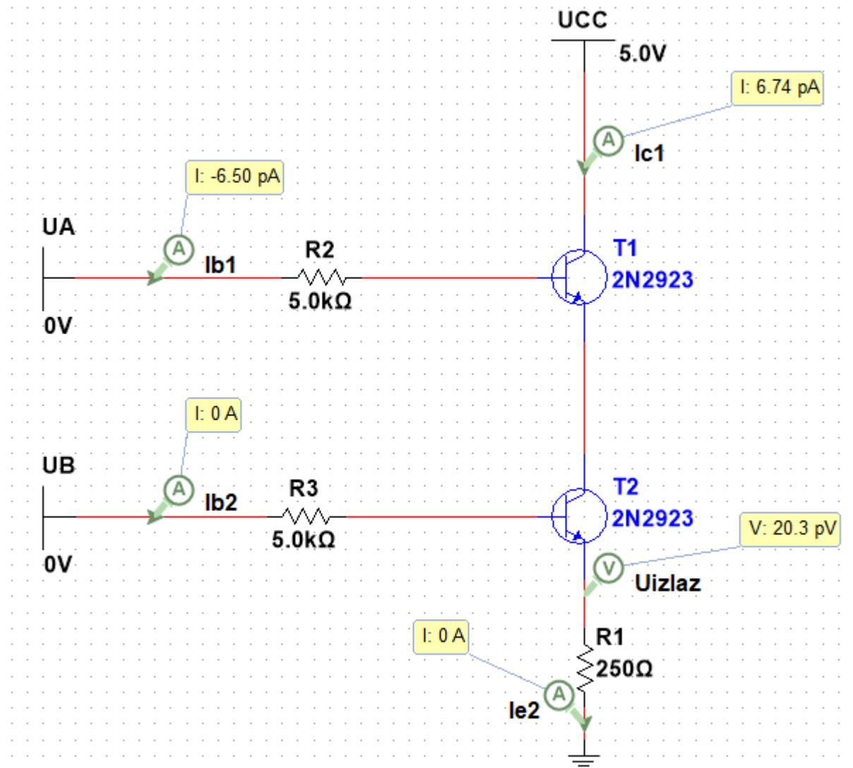
Slika 27. Shema logičke operacije I s bipolarnim tranzistorom (1).
