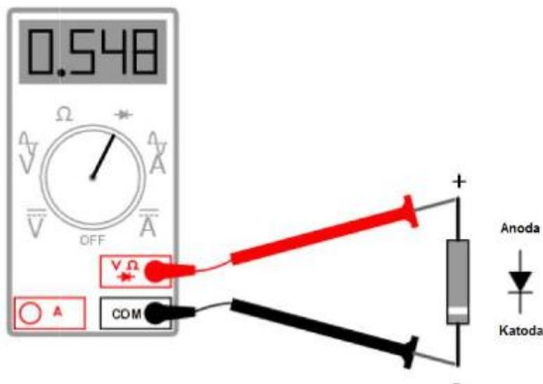
**Slika 12.** Predodžba mjerenja napona direktno spojenog PN spoja.
