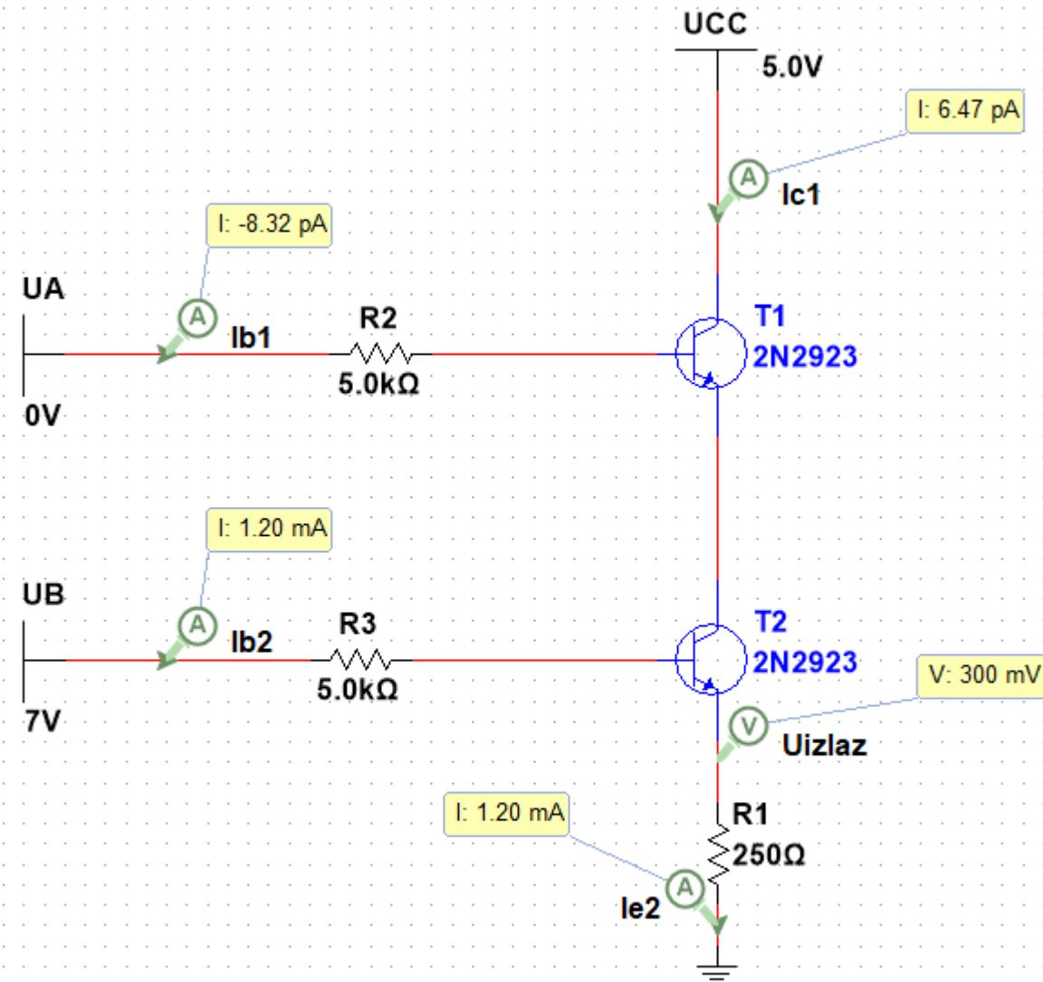
Slika 29. Shema logičke operacije I s bipolarnim tranzistorom (3) .
