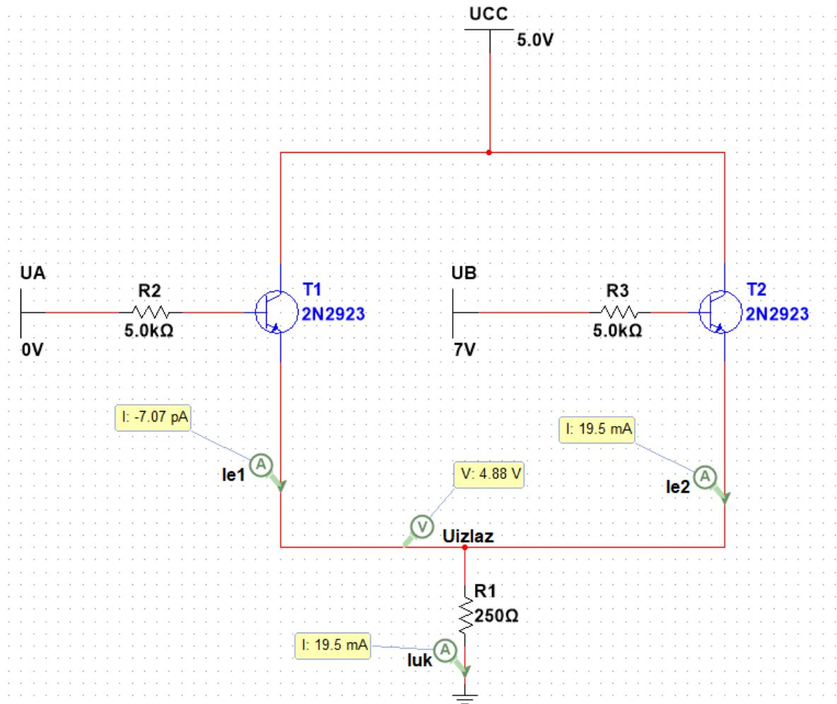
**Slika 37.** Shema logičke operacije ILI s bipolarnim tranzistorom (3) .
