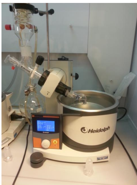
Slika 8: Uparavanje uzorka na Rotavapor-u
