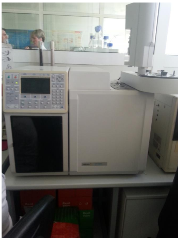
Slika 12: uređaj Varian GC CP 3800, Slika 13: Utori za stavljanje uzoraka za analizu
