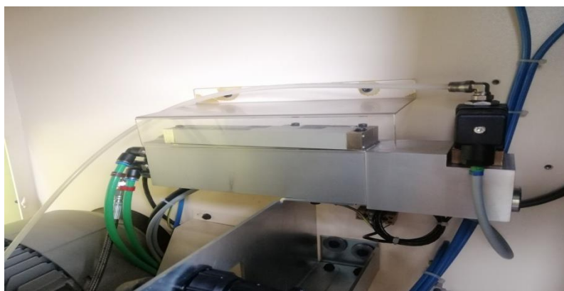
Slika 12 Mjerna jedinica isporuke injektora
