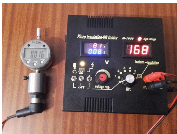
Slika 41 Mjerenje snage piezo magneta
