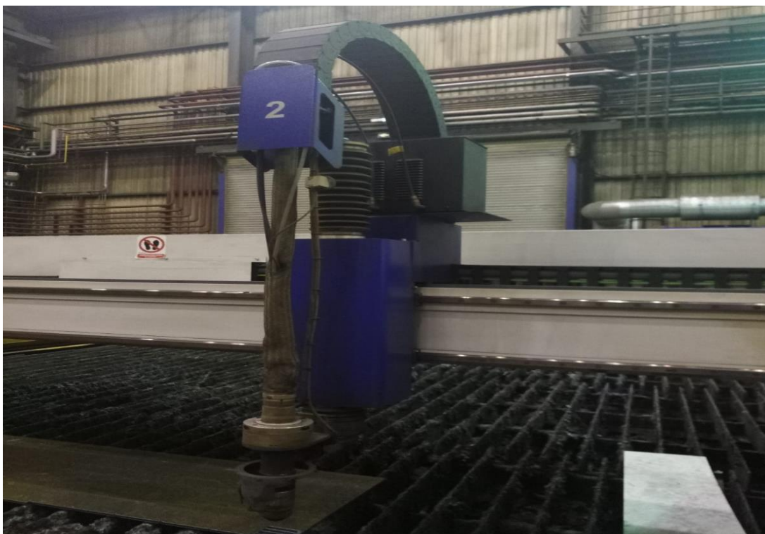
Slika 28. Stroj za CNC plinsko / plazma rezanje – nosač gorionika
