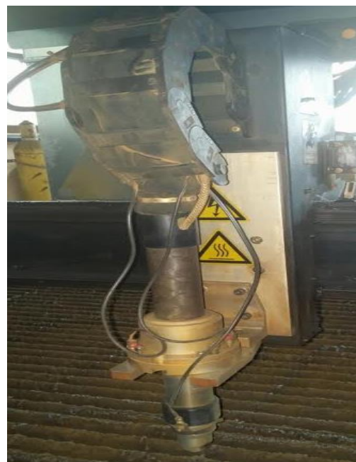
Slika 22. Pištolj kompjuterski vođene plazma rezačice
