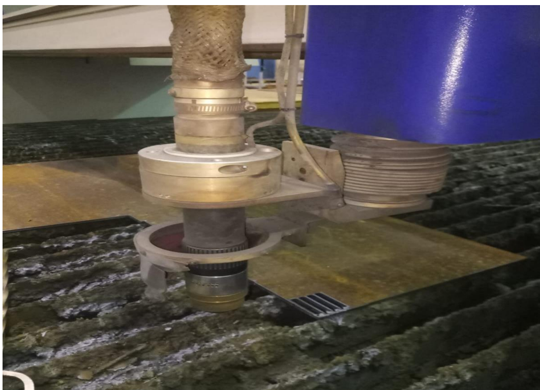
Slika 29. Stroj za CNC plinsko / plazma rezanje – gorionik
