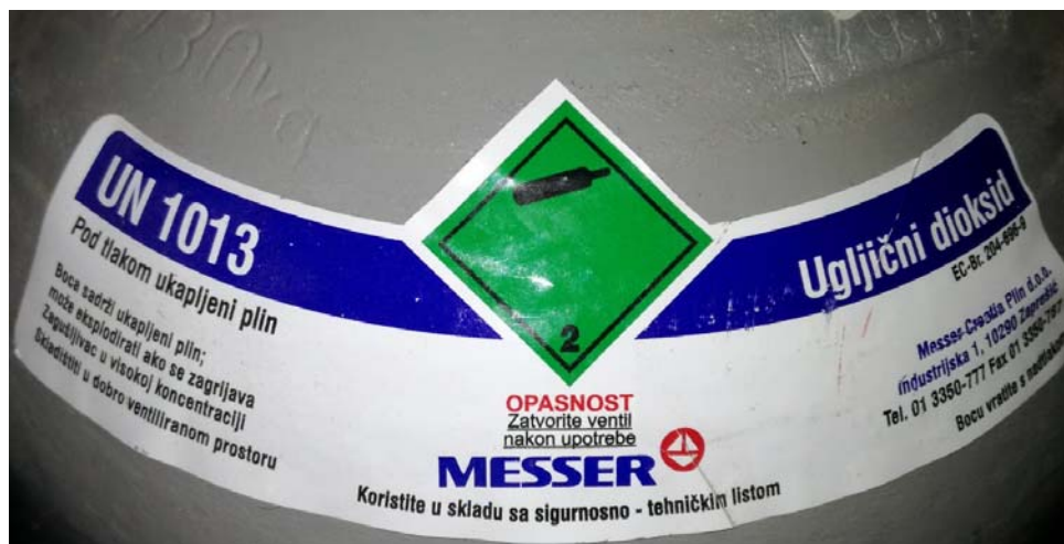
Slika 20. Plin UN1013, odnosno ugljični dioksid za MAG postupak zavarivanja
