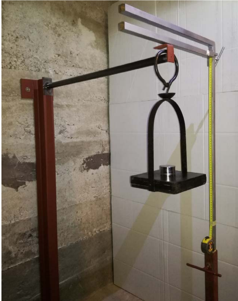
Slika 21. Eksperiment; konzola opterećena silom na kraku
