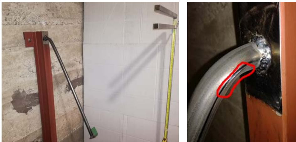
Slika 25. Maksimalno savinut cijevni štap konzole, cijev promjera 21.3\text{mm}
