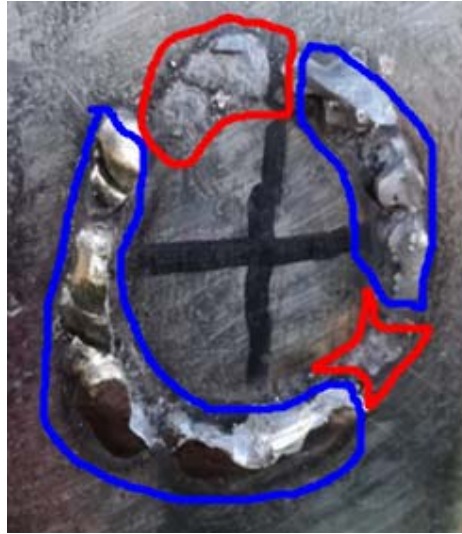
Slika 27. Odlomljeni zavar, eksperiment sa cijevi promjera 26.9mm
