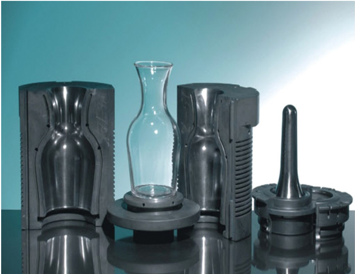
Slika 22. Prikaz alata sa gotovim proizvodom [3]
