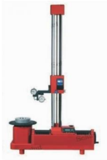
Slika 9. Uređaj za prednamještanje alata [18]
