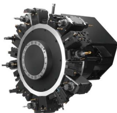
Slika 5.7. Revolverska glava sa 20 alata [9]
