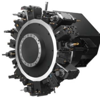
Slika 5.7. Revolverska glava sa 20 alata [9]
