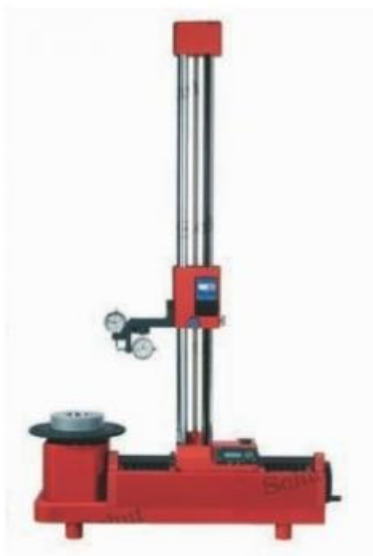
Slika 9. Uređaj za prednamještanje alata [18]
