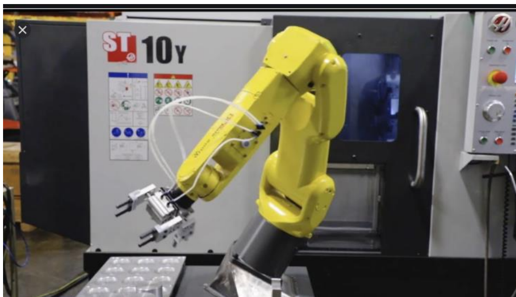
Slika 11. Automatska izmjena obradaka pomoću robota [16]
