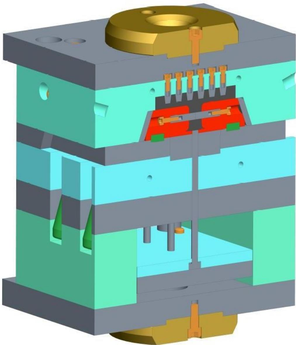
Presjek 3D modela kalupa
