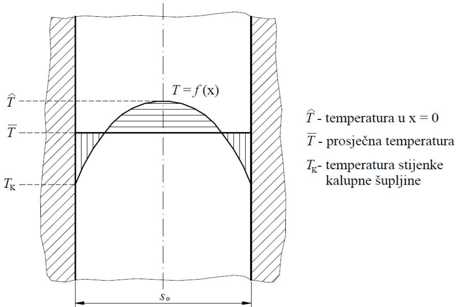
Slika 4.23: Kriteriji određivanja temperature postojanosti oblika otpreska [2]
