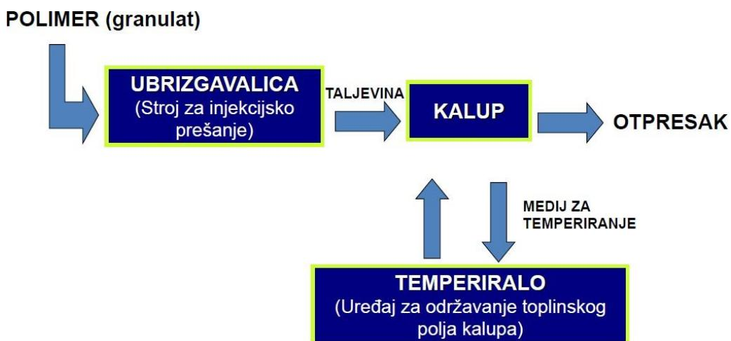
Slika 2.1: Shema sustava za injekcijsko prešanje [8]
