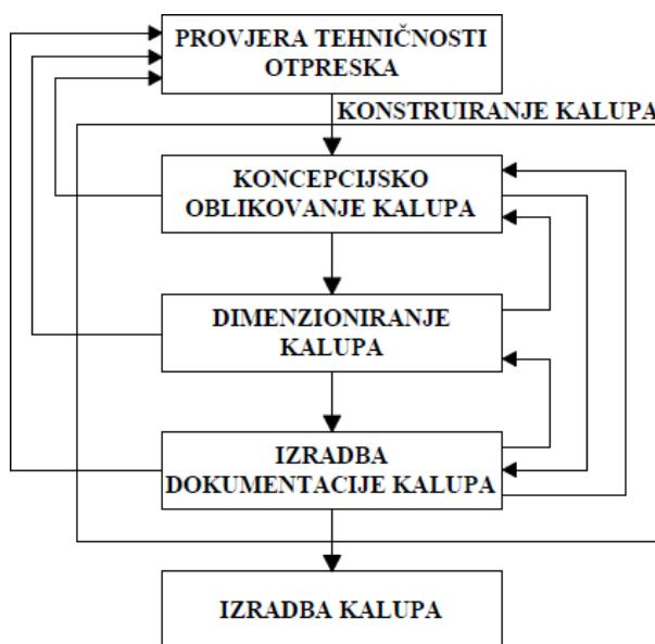
Slika 4.1: Temeljne faze konstruiranja kalupa za injekcijsko prešanje [2]
