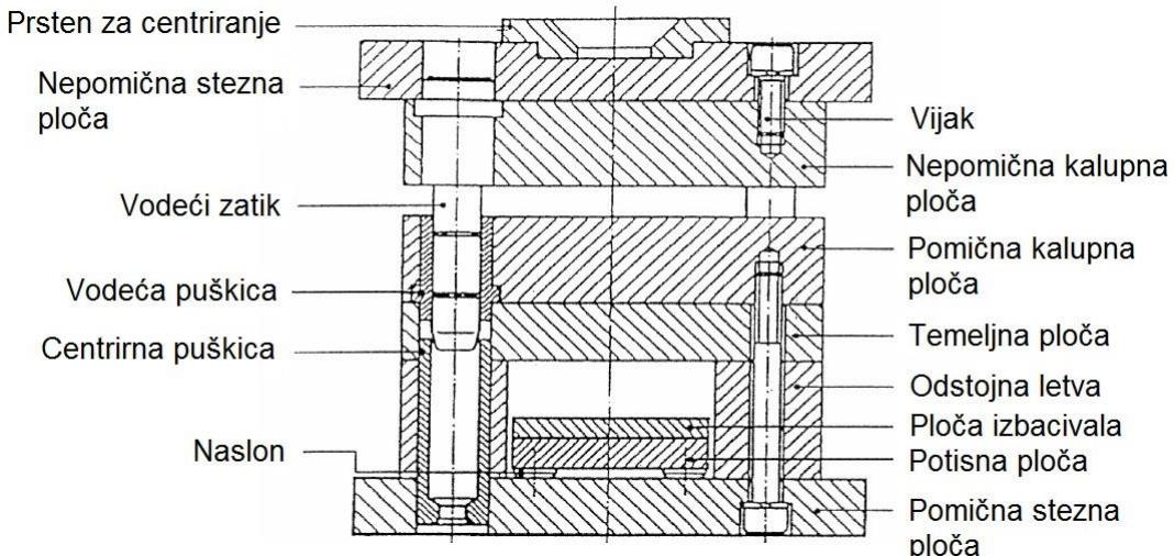
Slika 3.1: Dijelovi kućišta kalupa [2]
