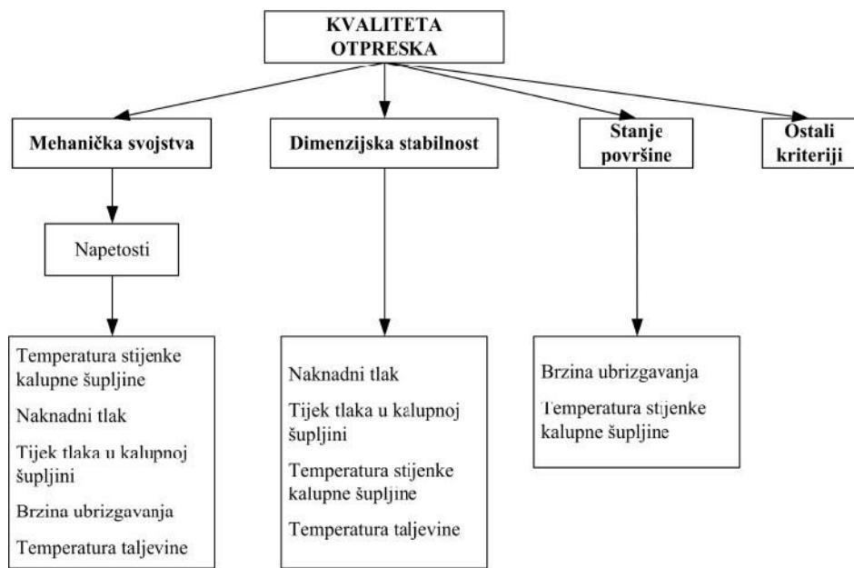
Slika 2.3: Kvaliteta otpreska u ovisnosti o parametrima prerađbe [4]
