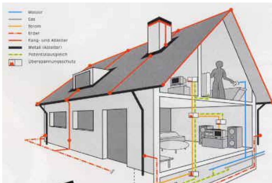
Slika 8. Predodžba vanjski i unutarnji sustav zaštite [20]
