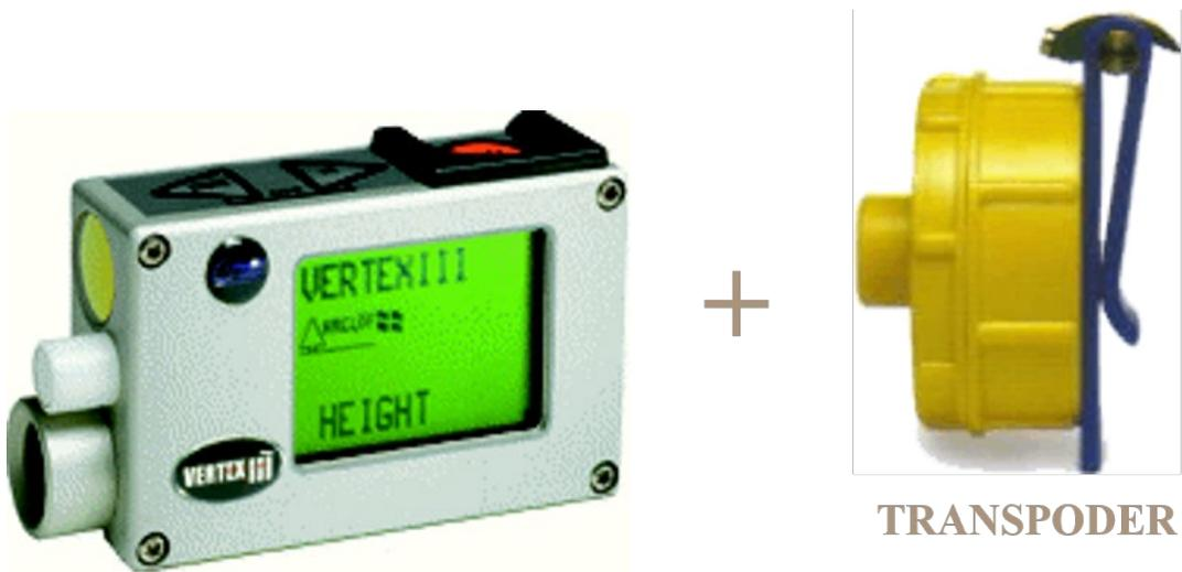
Slika 1. Vertex uređaj i transponder
