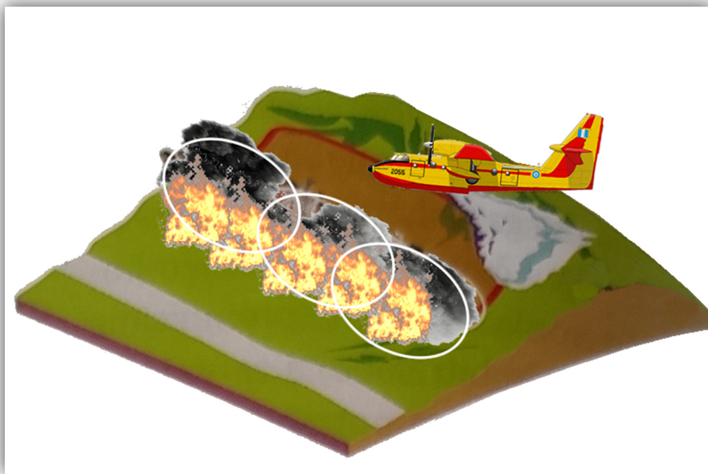
Slika 27. Metoda izravnog udara [5]
