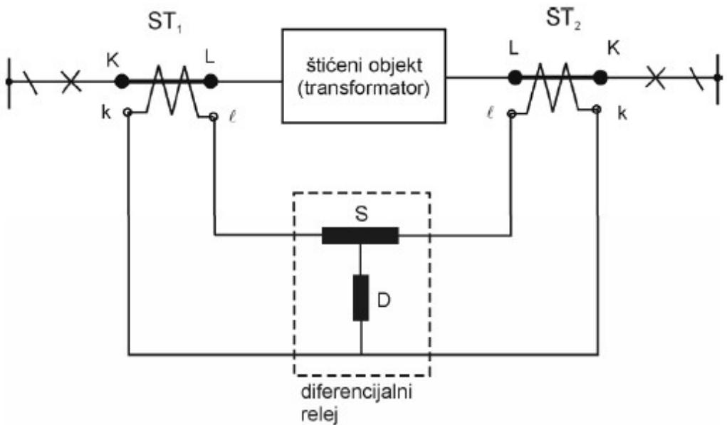
Slika 9. Priključak stabilne diferencijalne zaštite [19]
