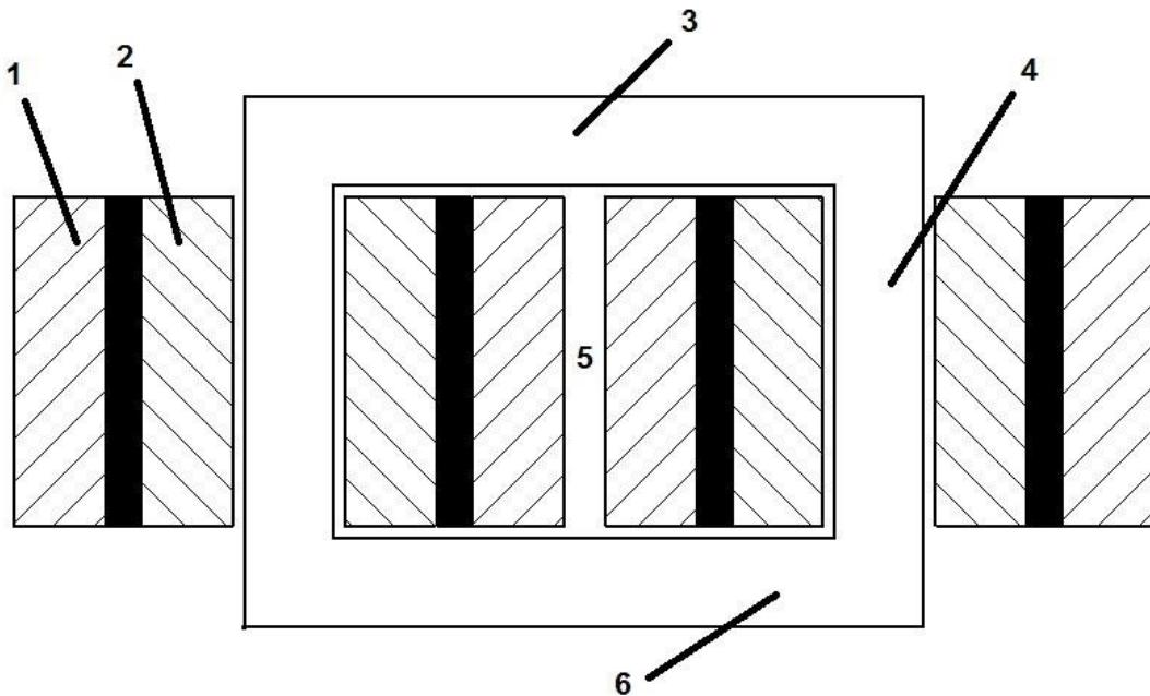
Slika 1. Jezgrasta izvedba jednofaznog transformatora [8]
