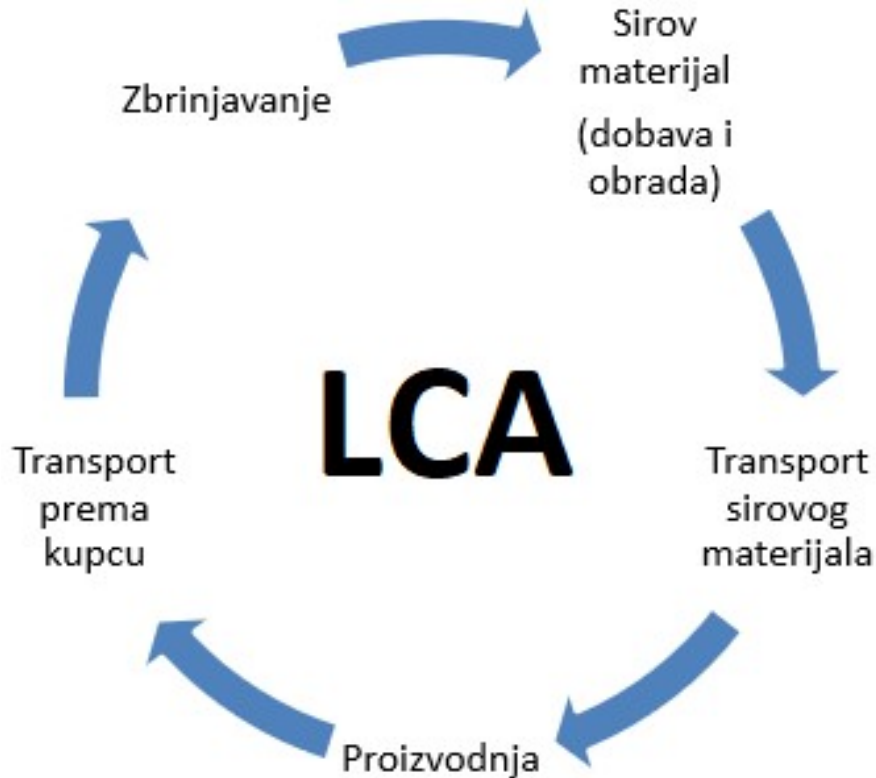
Slika 8. Životni vijek transformatora (LCA)
