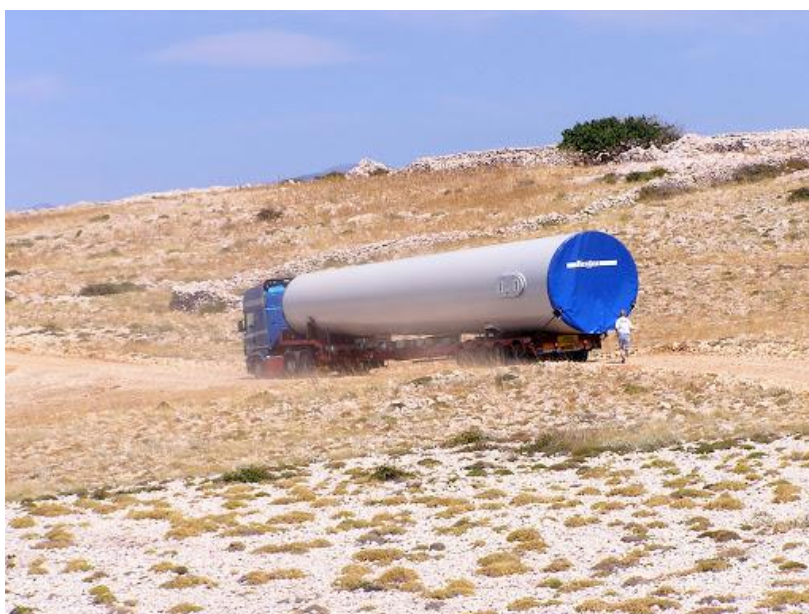
Slika 8. Transport segmenata stupova
