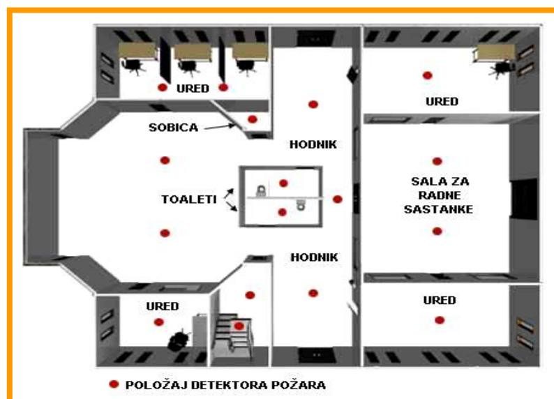
Slika 15. Pravilno postavljeni javljači (detektori)
