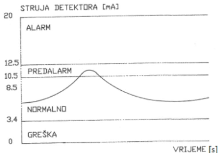
Slika 13. Promjena stanja javljača o vremenu detekcija predalarme
