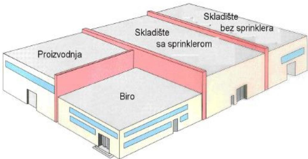
Slika 5. Formiranje požarnih sektora
