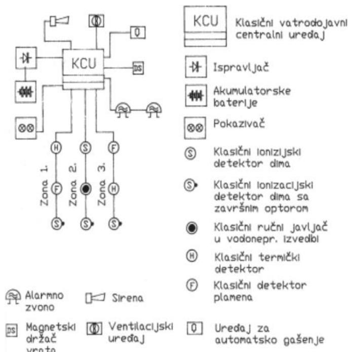
Slika 6. Blok shema klasičnog vatrodojavnog sustava [1]
