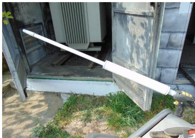
Slika 12. Patentirana motka za čišćenje pod naponom
