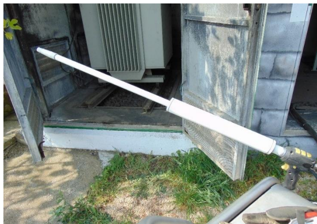
Slika 12. Patentirana motka za čišćenje pod naponom
