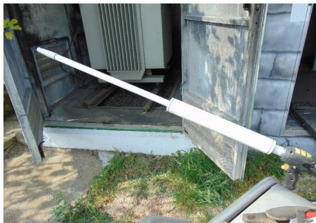
Slika 12. Patentirana motka za čišćenje pod naponom
