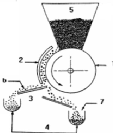
**Slika 4.** Shematski prikaz pulpiranja ploda kave (Illy, 1992.)
