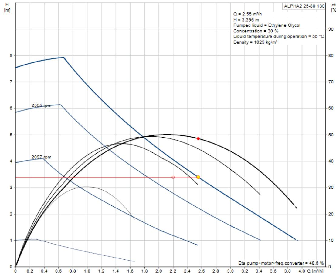
Slika 6.13. Dijagram radne točke pumpe Grundfos ALPHA2 25-80 130 [12]
