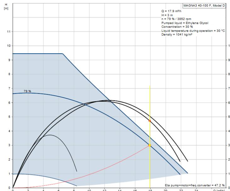
Slika 6.23. Dijagram radne točke pumpe Grundfos MAGNA3 40–100 F [12]
