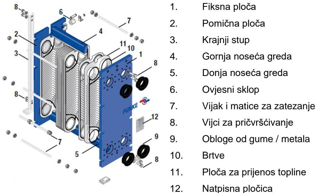
Slika 6.1. Sklopnji izgled pločastog izmjenjivača [13]
