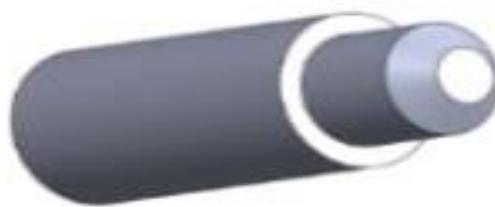
Slika 17 Zatik naprave nakon srednje grubog tokarenja
