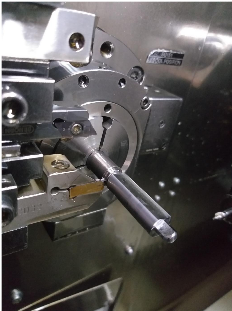
Slika 28 Operacija oslobodenja i natražno tokarenje
