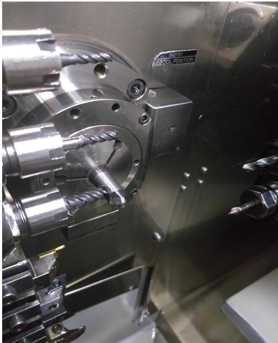
Slika 25 Glodanje tijela zatika naprave
