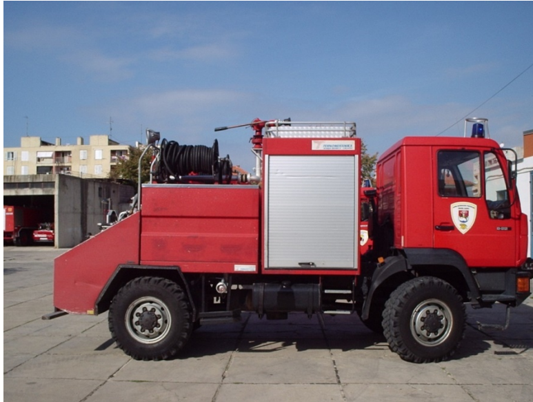
Sl. 35. Man 8.224 LAEC za gašenje šumskih požara [23]
