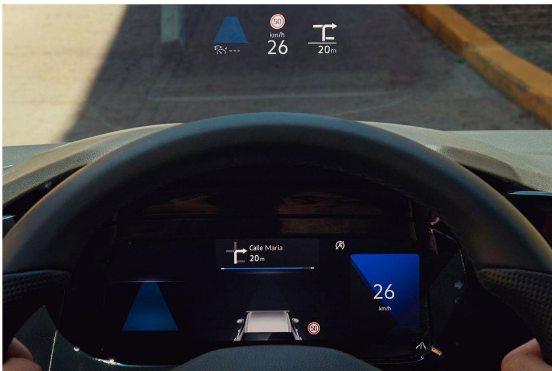
Slika 1. Predodžba projekcijskog HUD na vjetrobranskom staklu Volkswagenovog Golfa VIII (2020.), izvor: www.volkswagen.hr/novi-golf [3]
