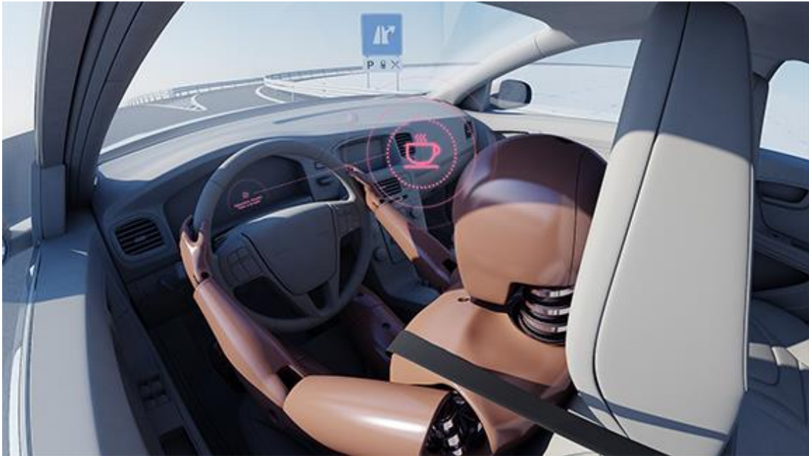
Slika 51. Predodžba sustav praćenja stanja vozača koji prepoznaje umor vozača npr. nakon duge vožnje, te mu predlaže odlazak na odmorište, izvor: euroncap
