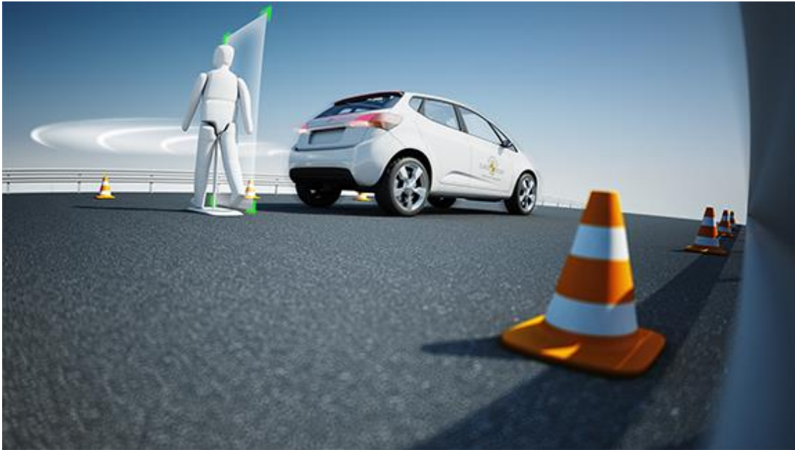
Slika 40. Ispitivanja izbjegavanja naleta na pješaka prilikom vožnje u nazad, izvor: www.euroncap.com/en/vehicle-safety/the-ratings-explained/vulnerable-road-user-vru-protection/aeb-pedestrian/ [43]
