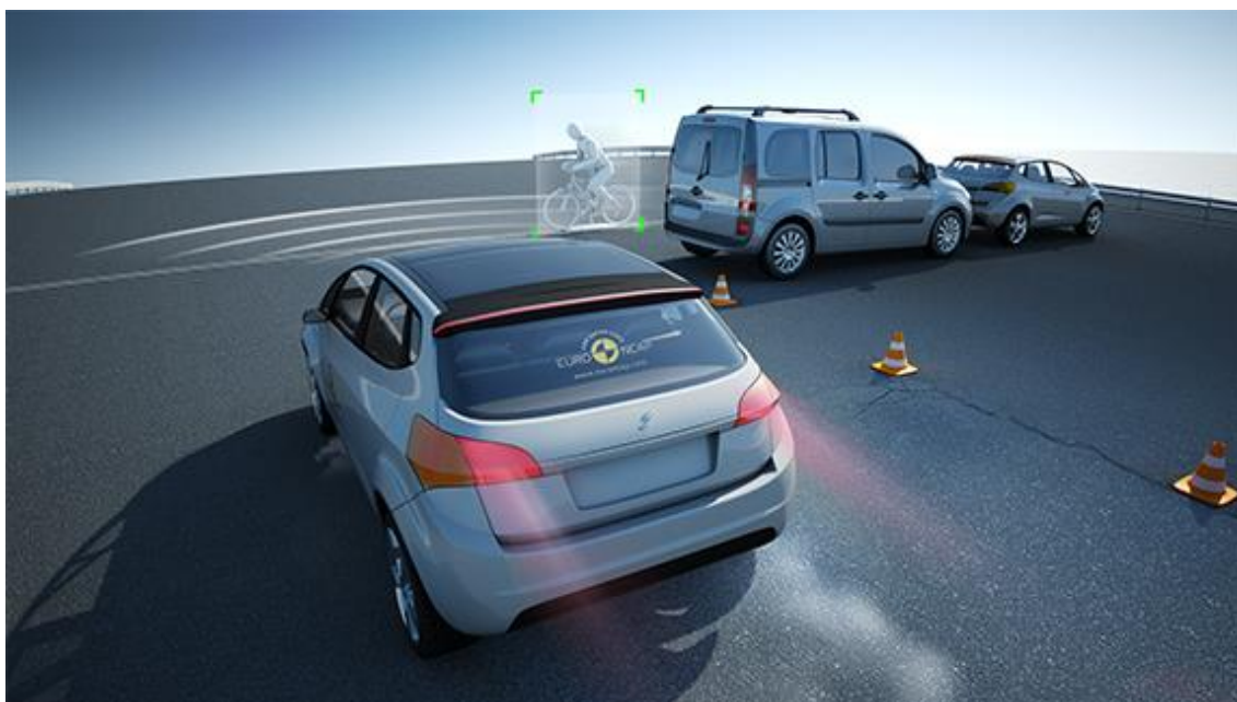
Slika 45. Predodžba ispitivanje izbjegavanja naleta vozila na biciklista zaklonjenog parkiranim vozilima, izvor: www.euroncap.com/en/vehicle-safety/the-ratings-explained/vulnerable-road-user-vru-protection/aeb-cyclist/ [44]
