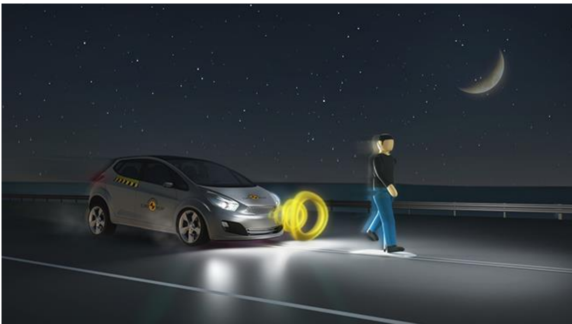
Slika 43. Ispitivanje izbjegavanja pješaka u uvjetima smanjene vidljivosti, izvor: www.euroncap.com/en/vehicle-safety/the-ratings-explained/vulnerable-road-user-vru-protection/aeb-pedestrian/ [43]
