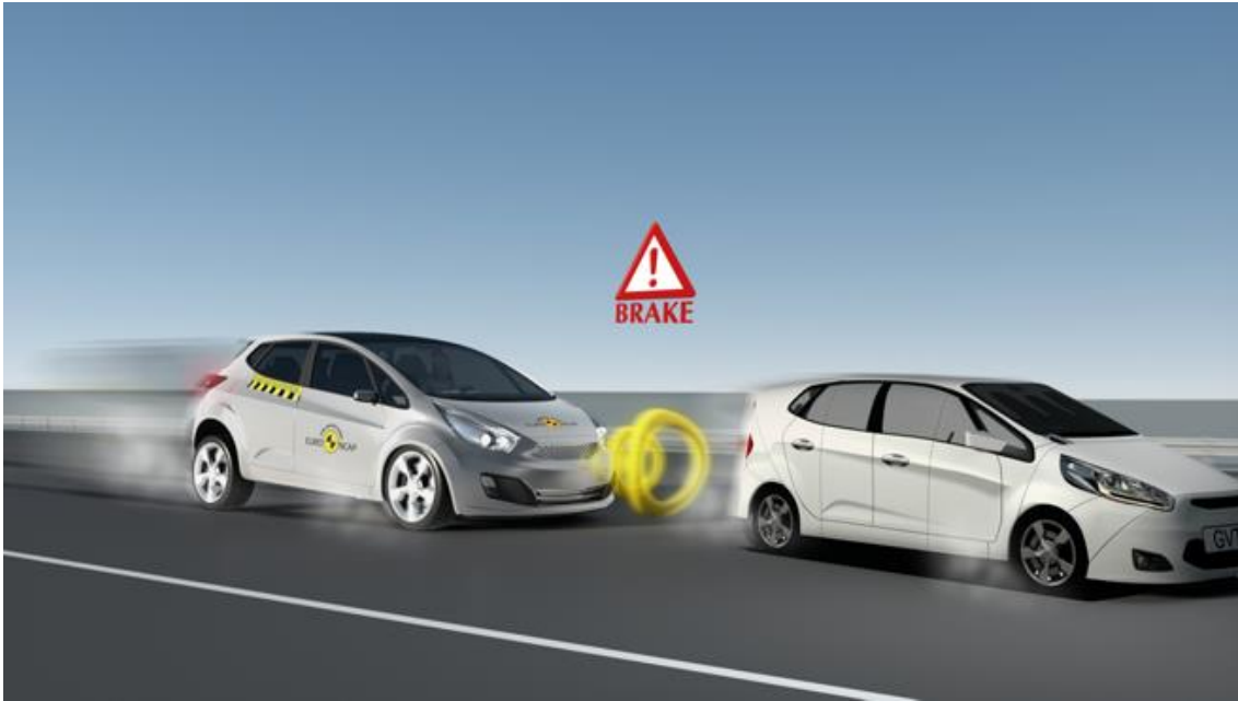
Slika 48. Predodžba ispitivanja zaustavljanja i izbjegavanja naleta na sporije vozilo pomoću AEB sustava, izvor: www.euroncap.com/en/vehicle-safety/the-ratings-explained/safety-assist/aeb-car-to-car/ [45]
