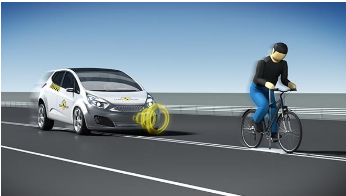
Slika 47. Izbjegavanje naleta vozila na biciklista koji vozi putanjom vozila, izvor: www.euroncap.com/en/vehicle-safety/the-ratings-explained/vulnerable-road-user-vru-protection/aeb-cyclist/ [44]
