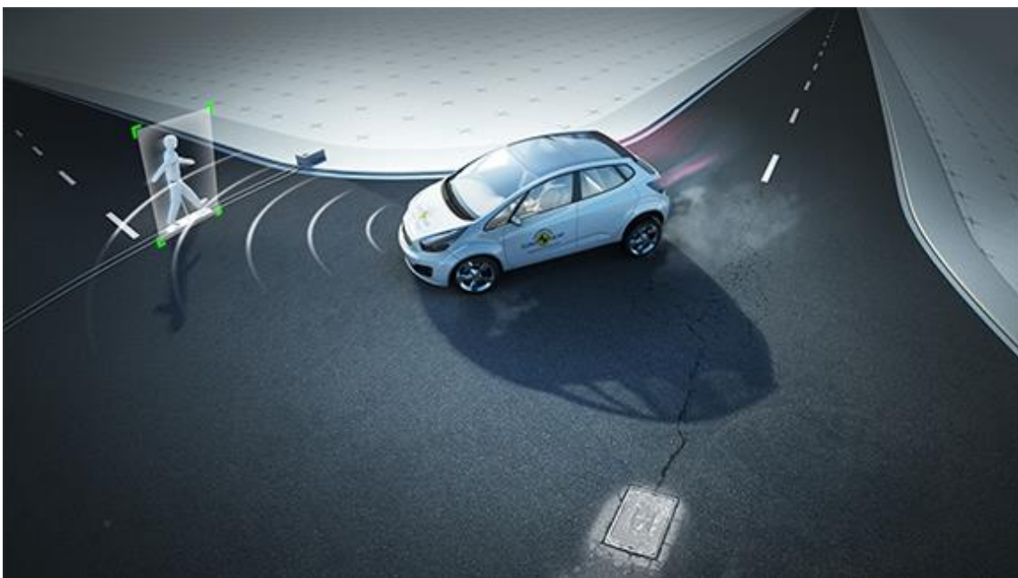
Slika 41. Ispitivanje izbjegavanje naleta na pješaka prilikom skretanja vozila, izvor: www.euroncap.com/en/vehicle-safety/the-ratings-explained/vulnerable-road-user-vru-protection/aeb-pedestrian/ [43]
