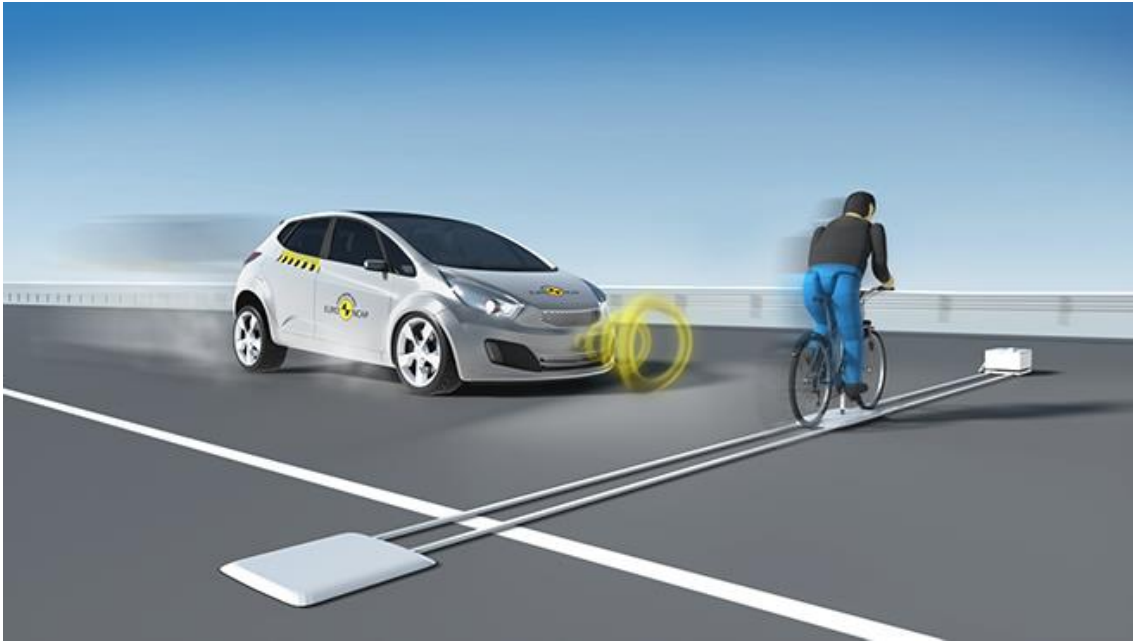
Slika 46. Izbjegavanje naleta vozila na biciklista koji vozi preko putanje vozila, izvor: www.euroncap.com/en/vehicle-safety/the-ratings-explained/vulnerable-road-user-vru-protection/aeb-cyclist/ [44]
