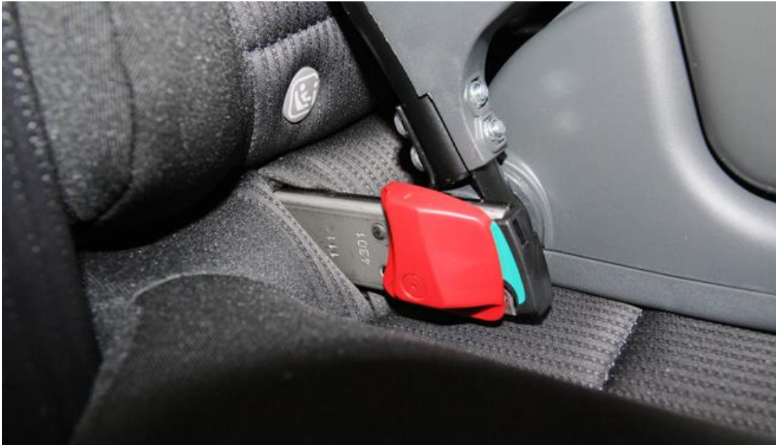
Slika 32. Mjesto vezivanja dječje sjedalice sa vozilom
