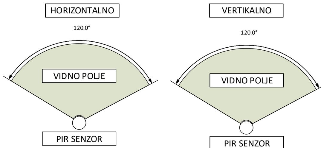
Slika 9. Prikaz vidnog polja senzora sa fresnelovom lećom
