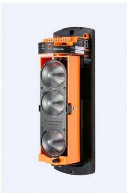
Slika 5. Fotoćelija koja se ugrađuje na stroj ispred opasnog mjesta obrade, kada radnik uđe dijelom tijela u obradni dio, stroj staje sa radom
