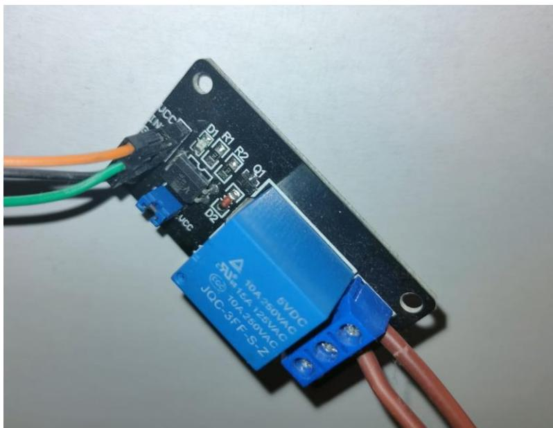
Slika 14. Prikaz jednofaznog releja korištenog u izradi PIR zaštitne naprave
