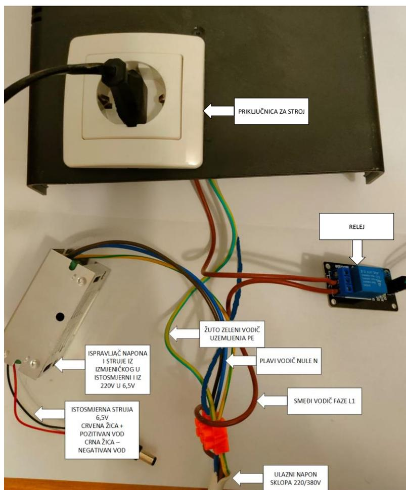
Slika 15. Prikaz napajanja sklopa i stroja
