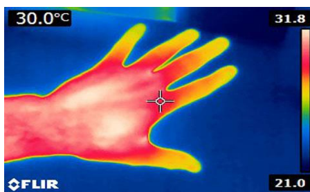
Slika 24. Izgled ruke snimljene IC kamerom, detekcija žute boje bi zaustavljala list pile
