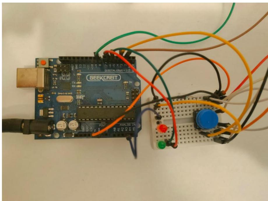
Slika 13. Vizualni prikaz priključnica na Arduino upravljačku jedinicu
