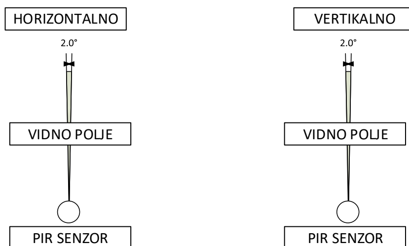
Slika 11. Prikaz vidnog polja senzora bez fresnelove leće i kada je snop ograničen termalno otpornom barijerom (sigurnosna zraka za detekciju pokreta)
