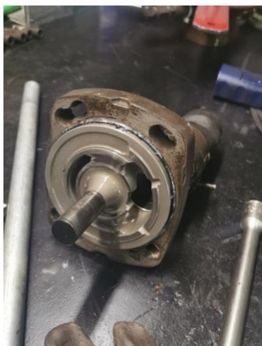
Slika 58. Prikaz oštećenja osovine pumpe
