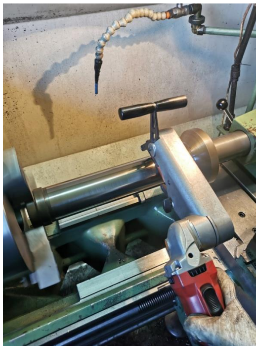
Slika 47. Proces poliranja klipnjače
