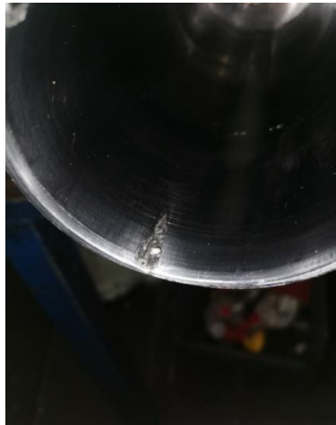
Slika 43. Udubljenje cijevi cilindra
