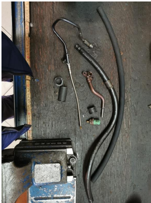
Slika 66. Promjena fleksibilnog hidrauličnog voda na servo crijevu
