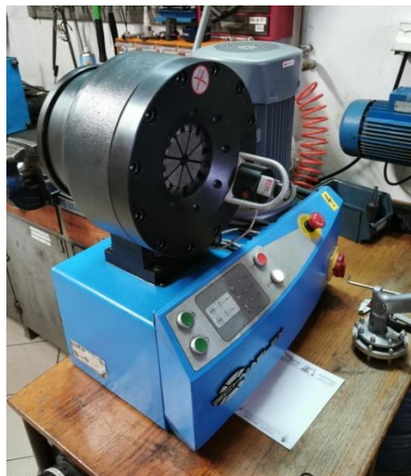
Slika 29. Hidraulična preša za izradu fleksibilnih cjevovoda
