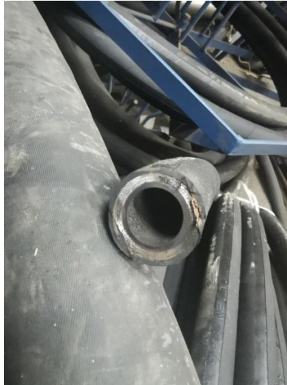
Slika 22. Fleksibilno hidraulično crijevo armirano čeličnom mrežicom
