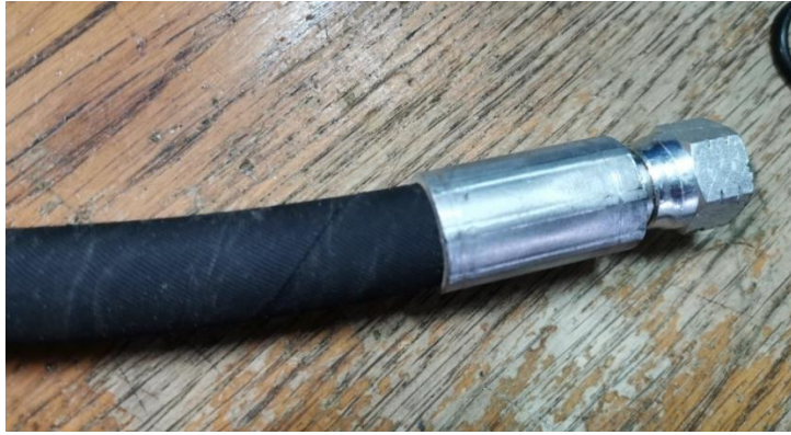
Slika 31. Primjer izrađenog hidrauličnog cjevovoda
