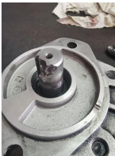
Slika 52. Oštećenje osovine pumpe
