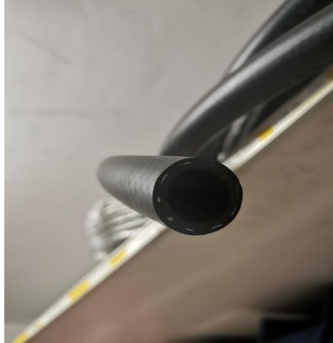
Slika 24. Fleksibilni hidraulični cjevovod armiran tekstilnom mrežicom
