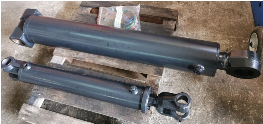
Slika 50. Završen postupak reparacije hidrauličnih cilindara
