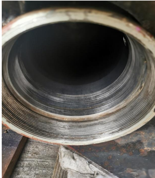
Slika 41. Oštećenja riseva po cijevi cilindra
