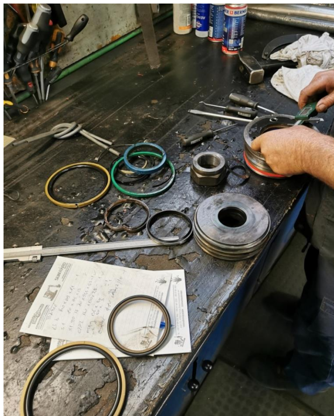
Slika 34. Promjena brtvi cilindra
