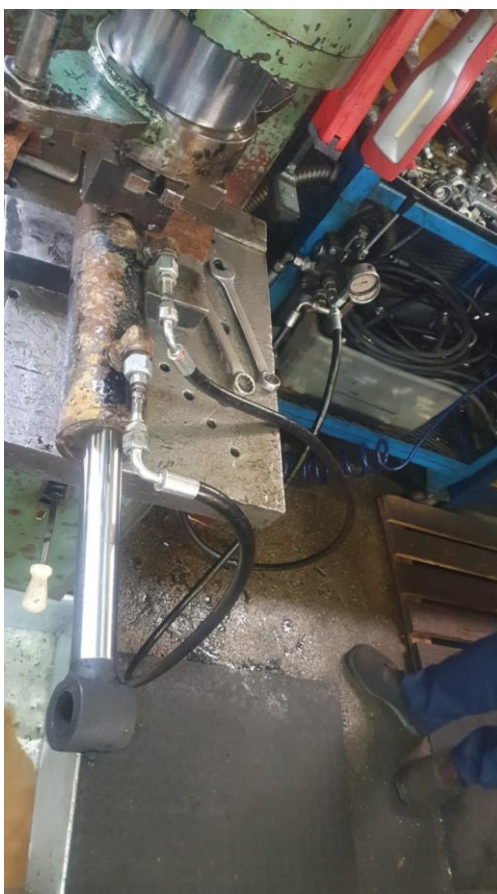
Slika 73. Proces ispitivanja nepropusnosti [2]
