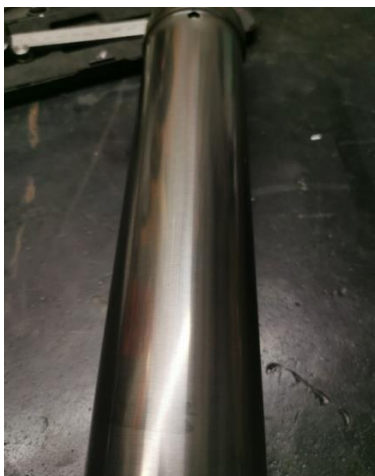
Slika 49. Klipnjača poslije poliranja
