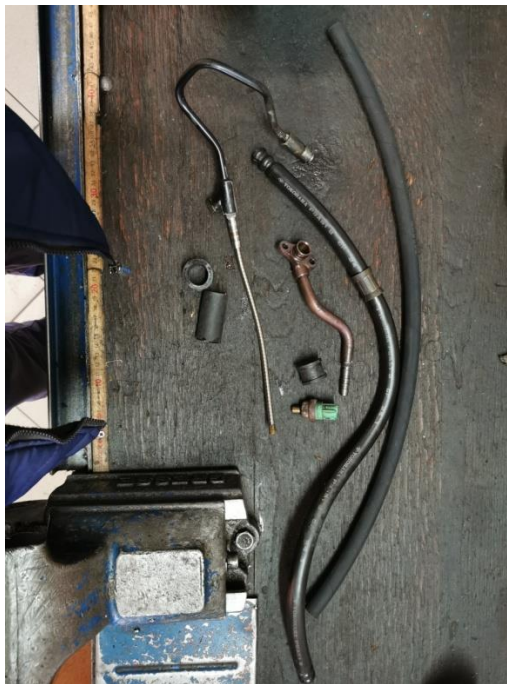
Slika 66. Promjena fleksibilnog hidrauličnog voda na servo crijevu
