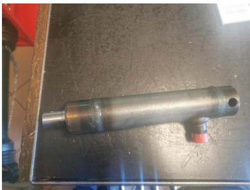
Slika 6. Jednoradni cilindar s oprugom
