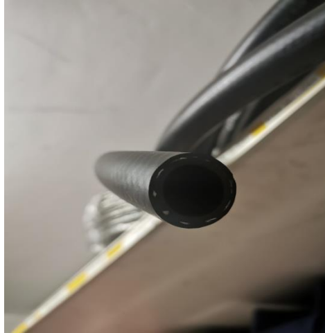
Slika 24. Fleksibilni hidraulični cjevovod armiran tekstilnom mrežicom
