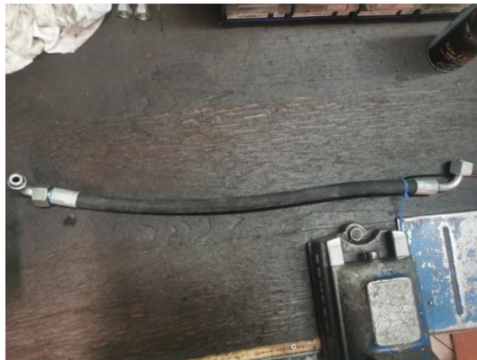
Slika 23. Primjer savitljivog hidrauličnog cjevovoda
