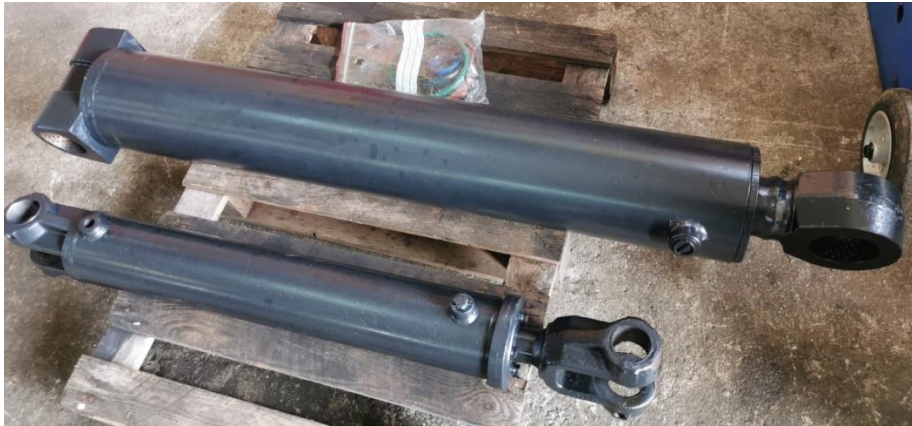
Slika 50. Završen postupak reparacije hidrauličnih cilindara
