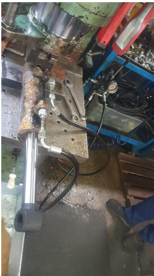
Slika 73. Proces ispitivanja nepropusnosti [2]
