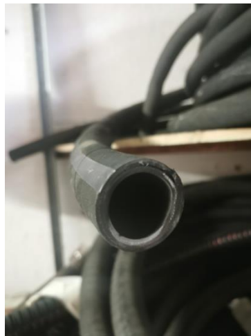
Slika 25. Fleksibilni hidraulični cjevovod jednostruko armiran čeličnom mrežicom
