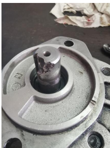
Slika 52. Oštećenje osovine pumpe
