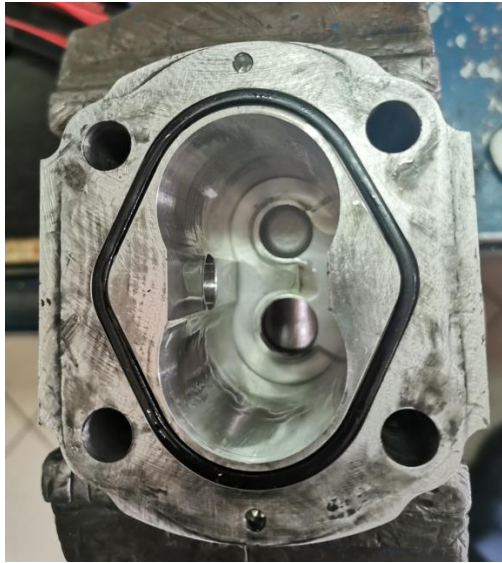
Slika 55. Unutrašnjost zupčaste pumpe
