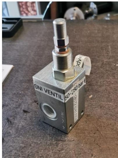
Slika 13. Ventil za ograničavanje tlaka "sigurnosni ventil"
