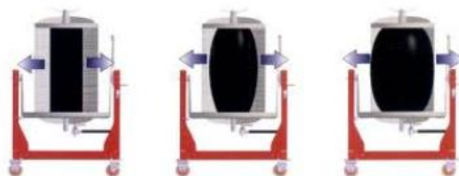
Slika 8. Shema širenja zračnice. [10]
