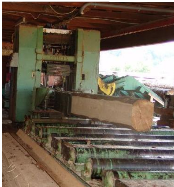
Slika 24. – Obličarka sa zaštitom nazubljenog valjka
