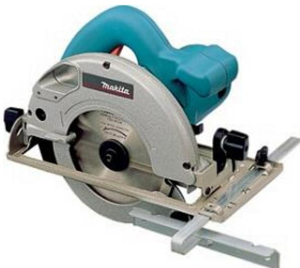
**Slika 12.** – Zaštićivanje ručne kružne pile
