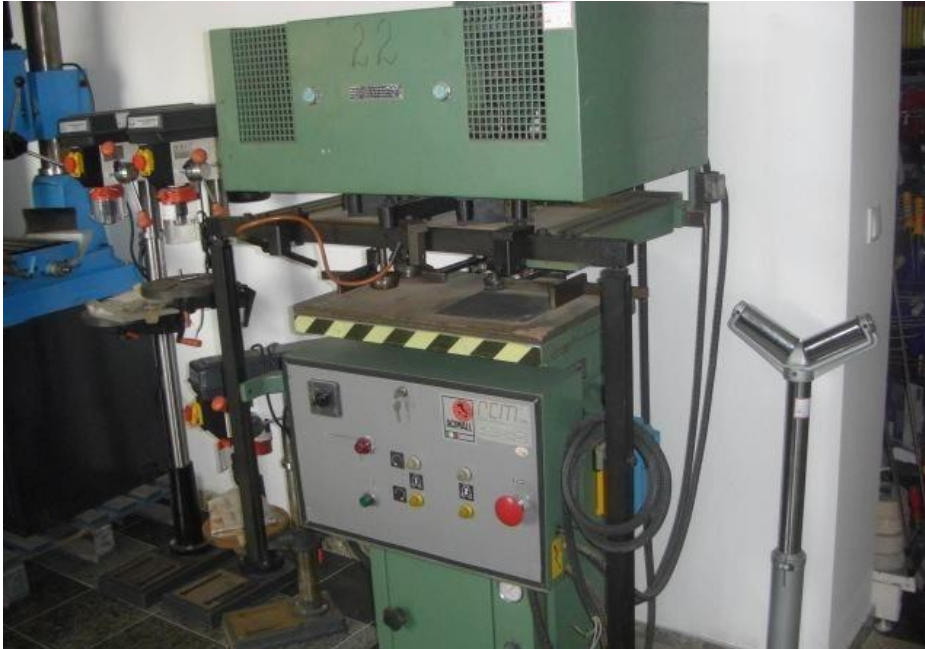
Slika 29.: Viševretena bušilica za drvo
