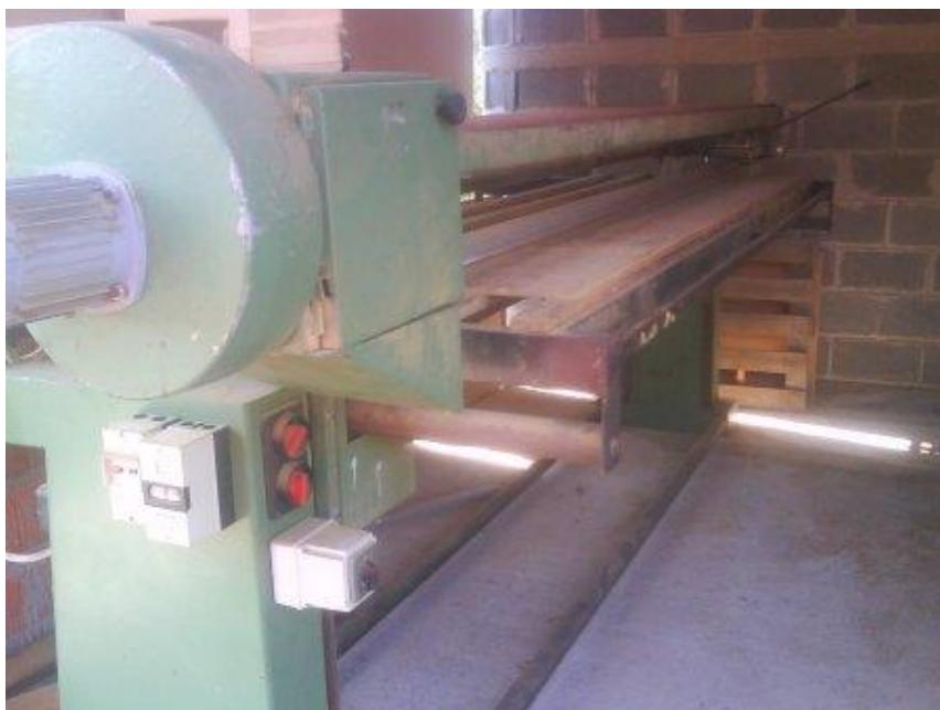
Slika 30.: Tračna brusilica za drvo
