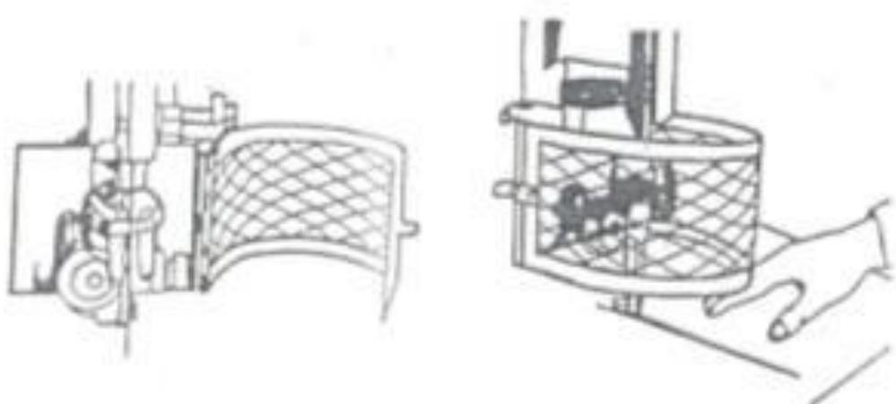
**Slika 16.** – Zaštićivanje radnog dijela pile metalnom napravom
