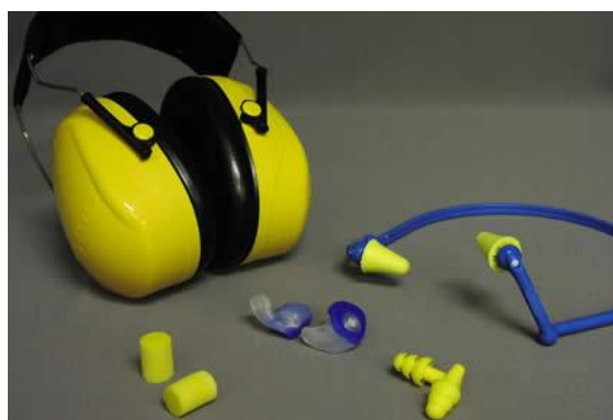
Slika 5. – Antifon, zaštitni čepići i zaštitna vata
