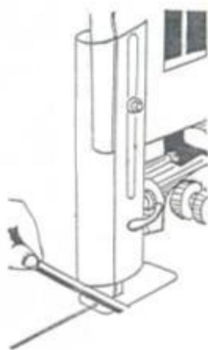
**Slika 17.** – Zaštićivanje radnog dijela pile plastičnim štitnikom
