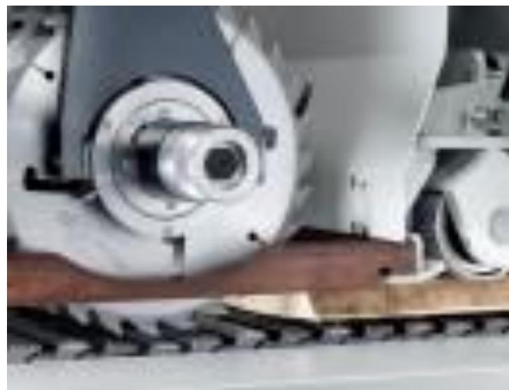
**Slika 18.** – Pomična zaštita na radnom dijelu trake
