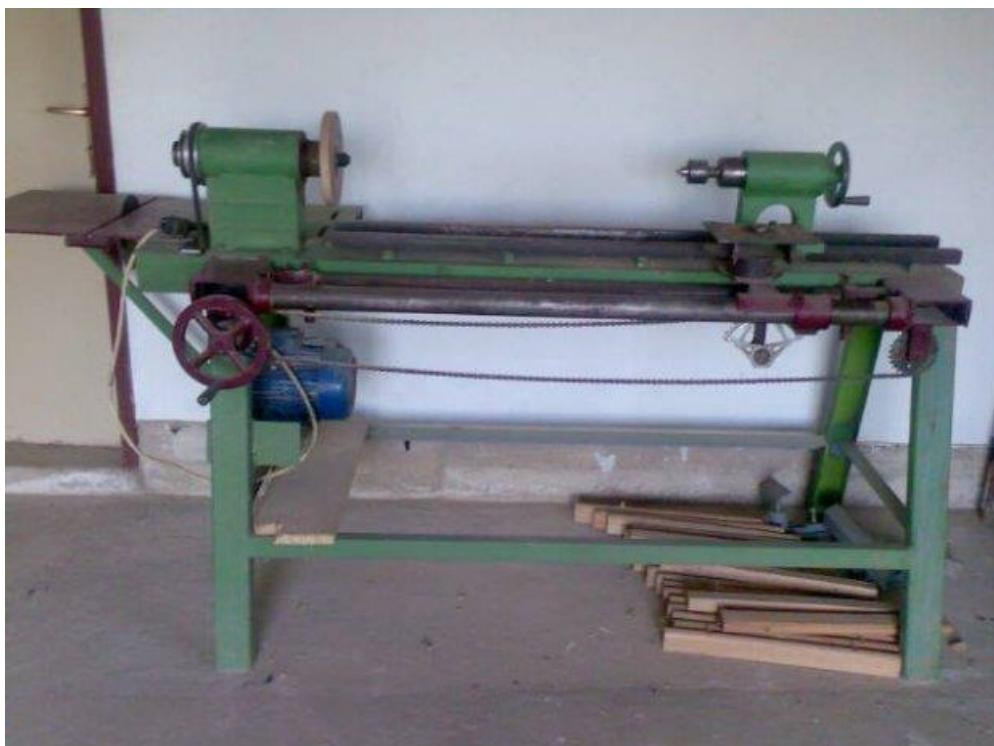
**Slika 31.: Tokarski stroj za drvo**
