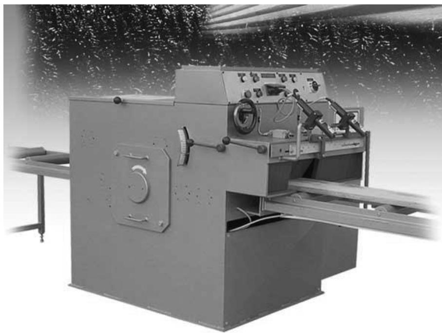
Slika 7. – Automatska kružna pila
