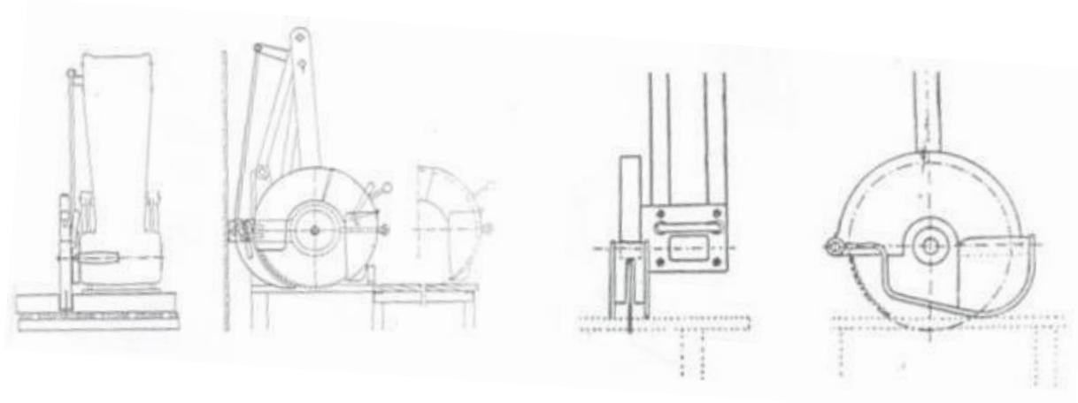
Slika 9. - Zaštićivanje povlačne pile( lijevo ); Zaštićivanje povlačne pile ( desno )
