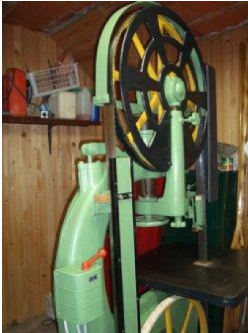
Slika 13. - Zaštićivanje kotača po obodu
