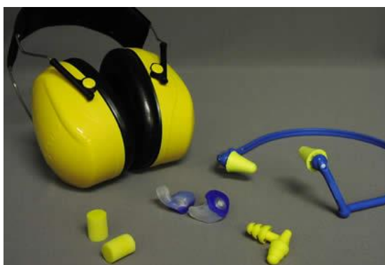
Slika 5. – Antifon, zaštitni čepići i zaštitna vata
