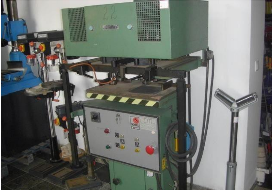
Slika 29.: Viševretena bušilica za drvo
