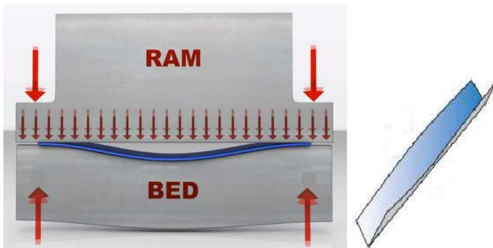
Slika 21. Elastična deformacija stroja i neravnomjerno savijen kutnik [10]
