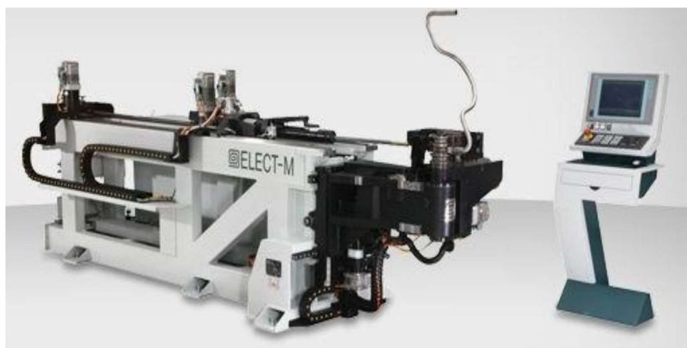
Slika 16. Stroj za savijanje cijevi tvrtke BLM Group [9]
