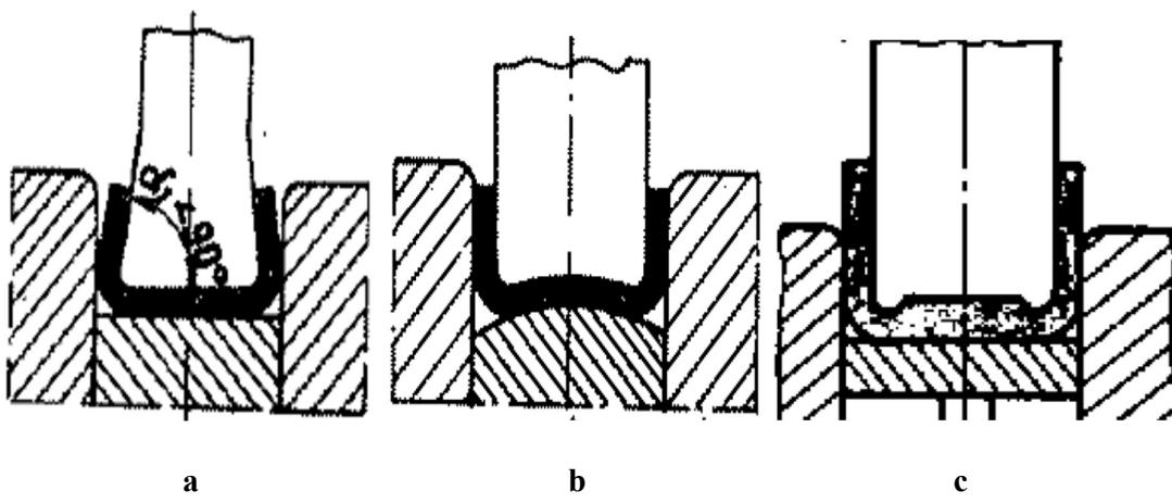
**Slika 4.** Kompenzacija elastičnog povrata prilikom savijanja dvostrukog kutnika [2]
