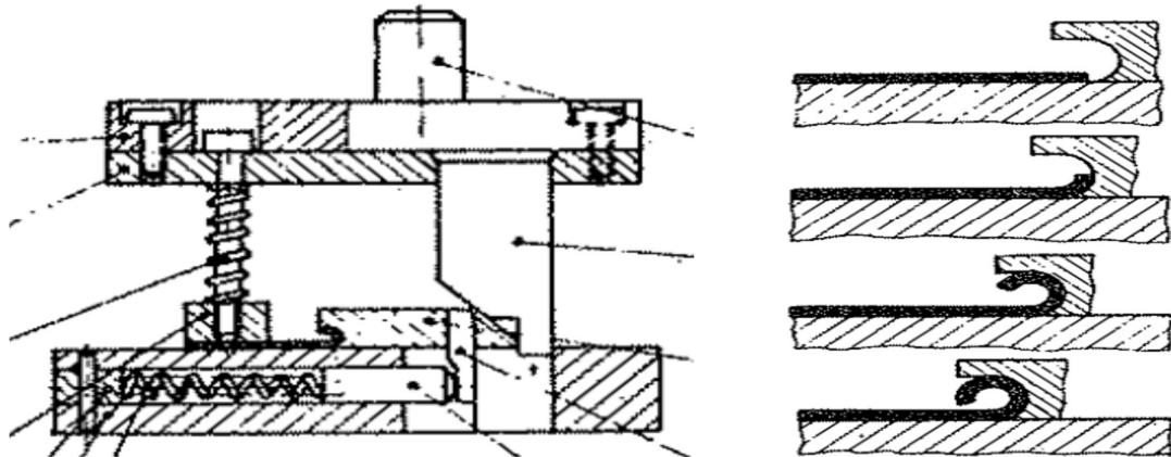
**Slika 10.** Alat za kružno zavijanje i faze procesa [2]
