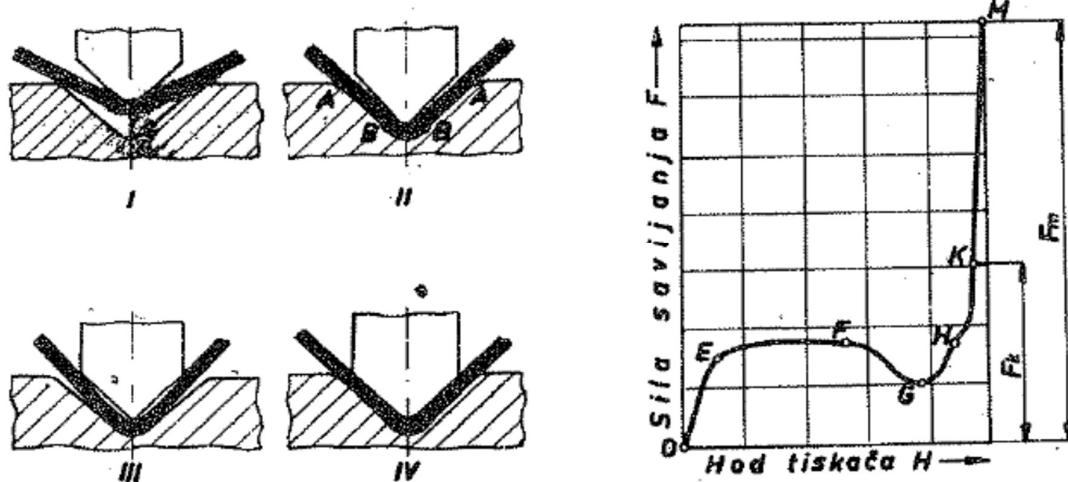
Slika 7. Savijanje V- profila u alatu, faze savijanja i tok sile [2]
