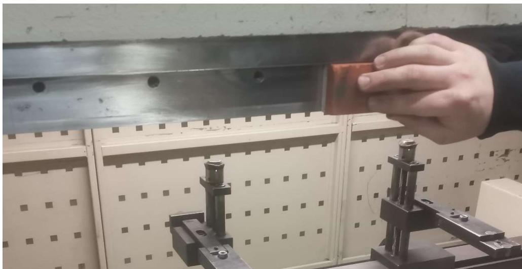
Slika 34. Priprema bočne površine na stroju na koje naliježu prihvavnici žiga [16]
