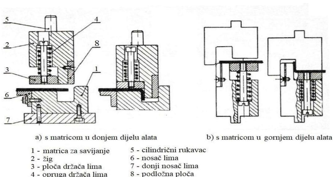
Slika 9. Konstrukcija alata za jednostrano savijanje [2]
