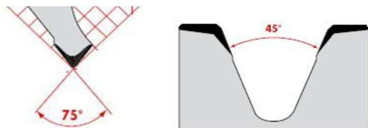
**Slika 30.** Kut alata za profilno savijanje [5]
