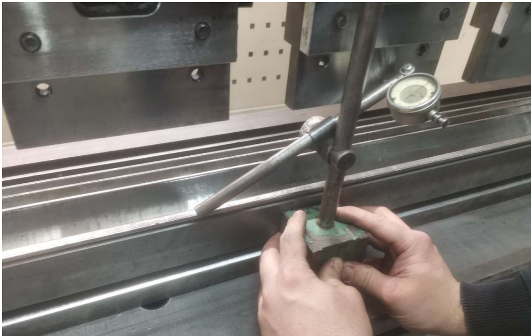
Slika 40. Mjerenje odstupanja od ravnosti bočne površine na koju se steže žig
