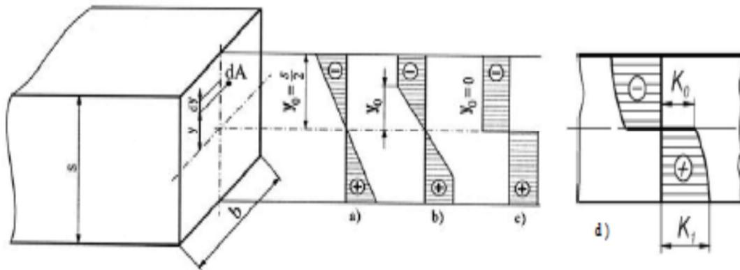
**Slika 17. Tangencijalna naprezanja kod savijanja; a) čisto elastično savijanje; b) elastično plastično savijanje deformacijaskog ojačavanja; c) čisto plastično savijanje bez ojačavanja; d) čisto plastično savijanje sa nelinearnim ojačavanjem [4]**
