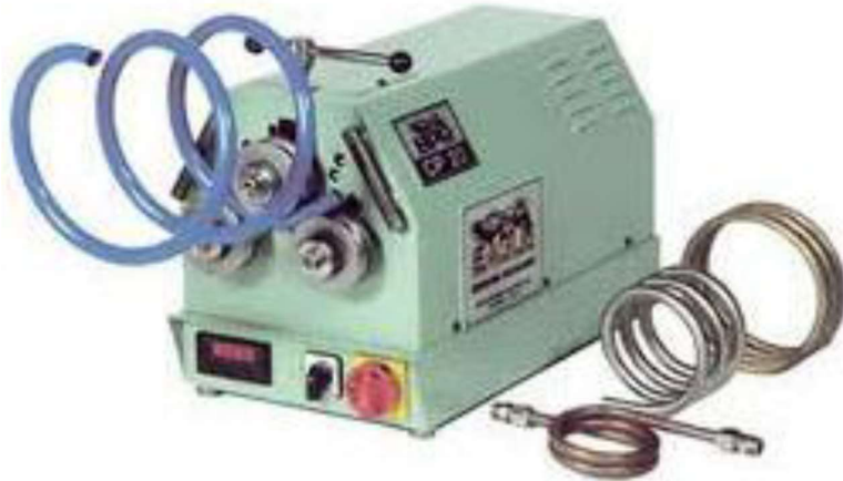
Slika 14. Stroj za savijanje profila manjih presjeka na valjcima [4]
