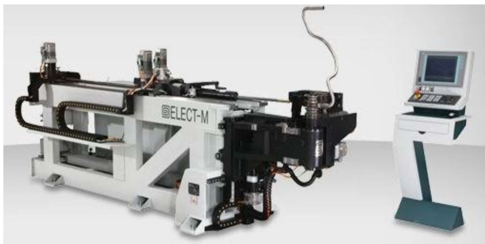
Slika 16. Stroj za savijanje cijevi tvrtke BLM Group [9]
