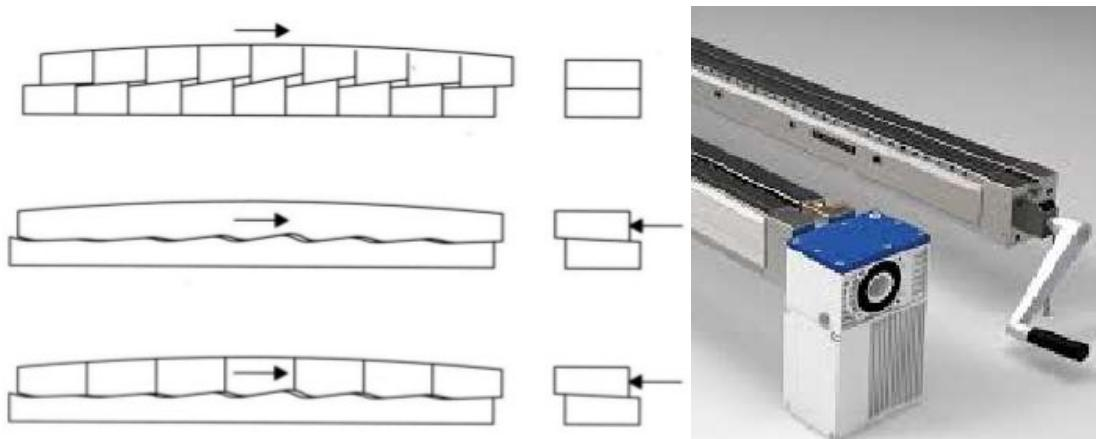
**Slika 22.** Mogući principi rada stolova za „bombažu“ te manulana i automatska regulacija [17]
