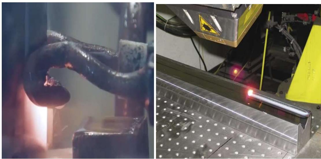
**Slika 32.** Postupak površinskog kaljenja alata za profilno savijanje; a) induksijsko; b) lasersko [15]
