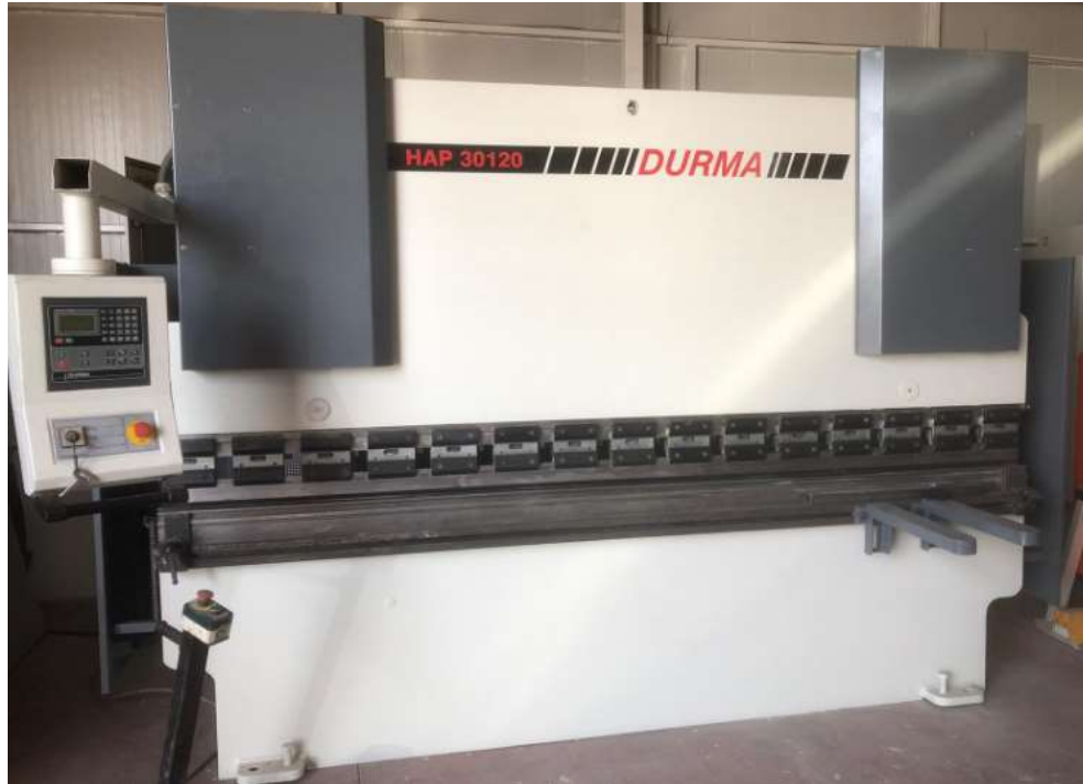
Slika 33. Preša za profilno savijanje Durma HAP 30120
