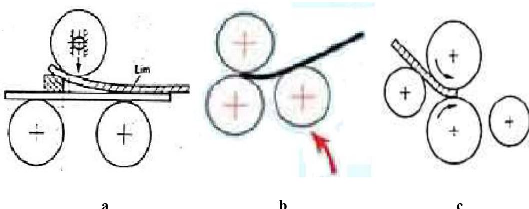
**Slika 13.** *Predsavijanje lima na valjcima; a) pomoću grede; b) pomoću premeštanja valjaka; c) predsavijanje na strojevima sa četiri valjka [1]*
