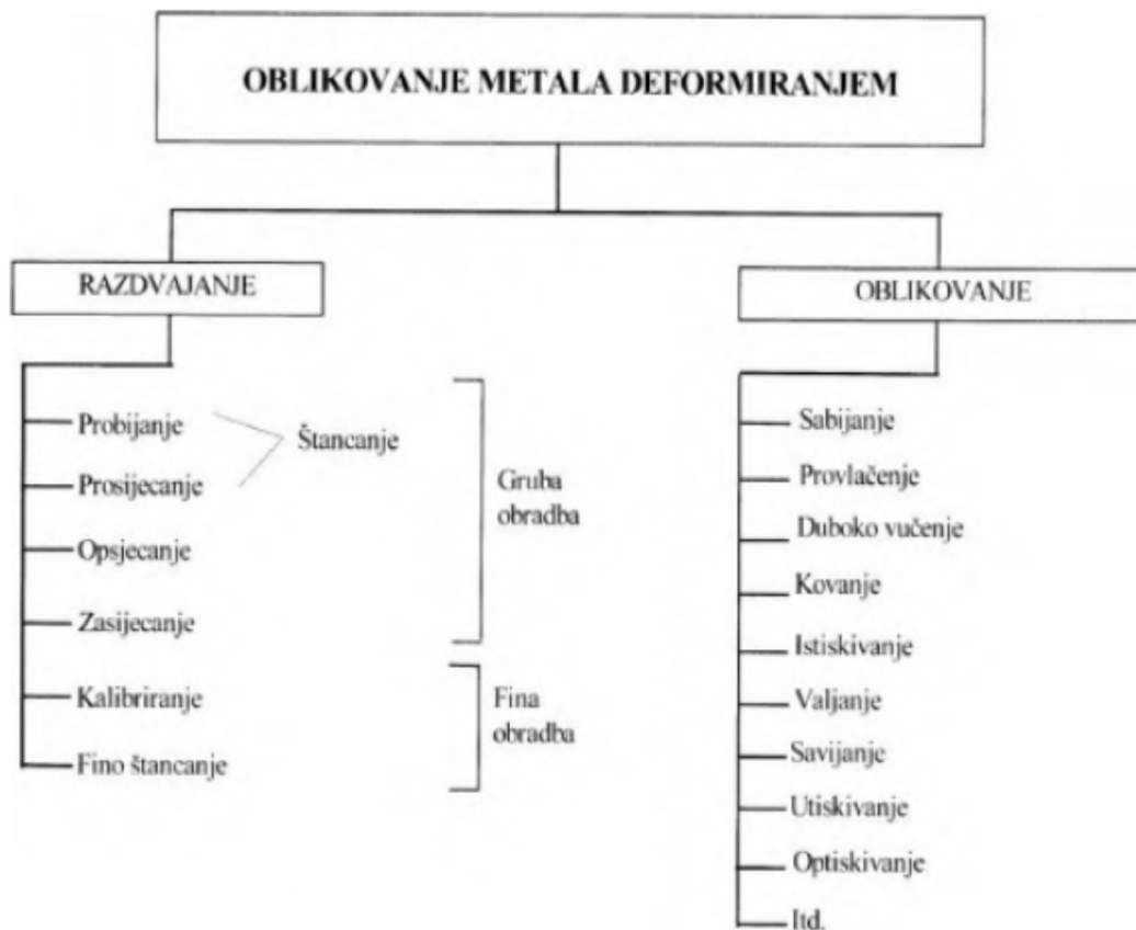
Slika 1. Podjela postupaka oblikovanja deformiranjem [3]
