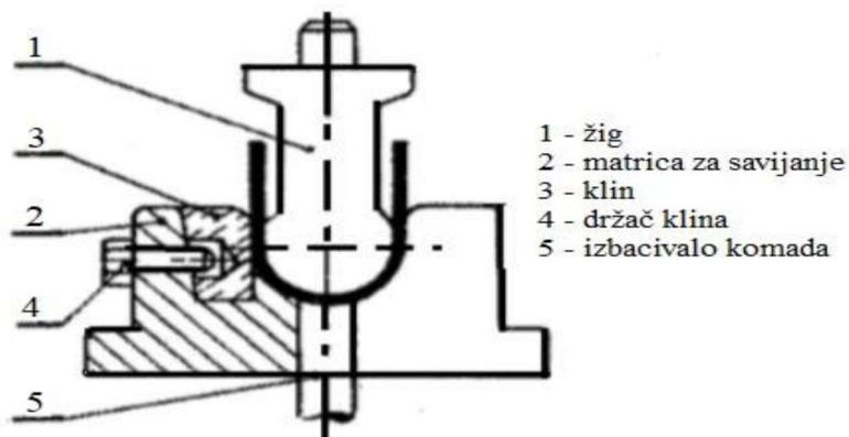
**Slika 5. Savijanje U-profila [3]**
