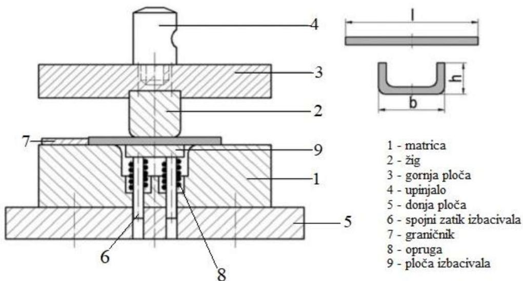
**Slika 2.** Alat za savijanje dvostrukog kutnika [7]
