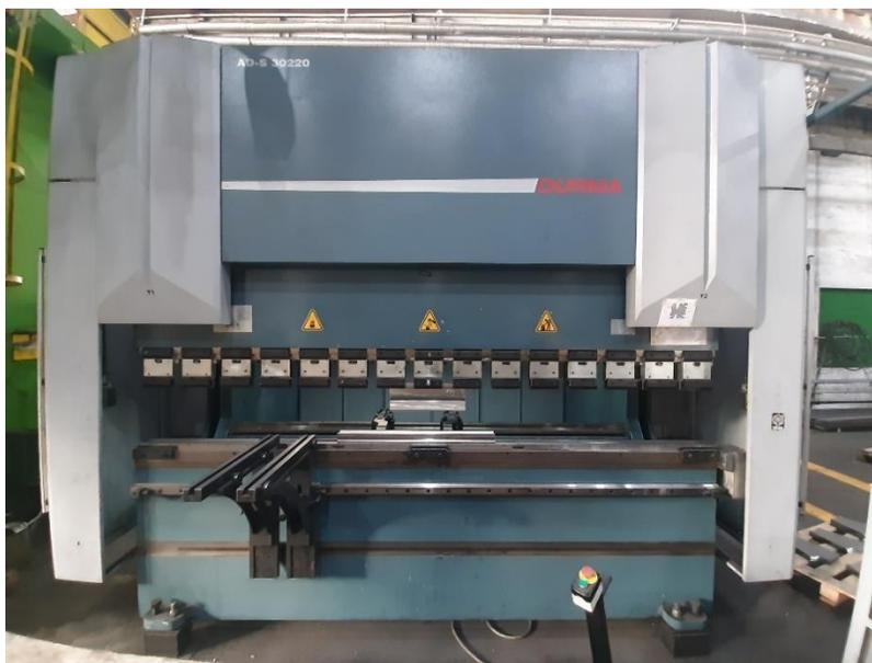
Slika 14. Hidraulična preša za savijanje lima
