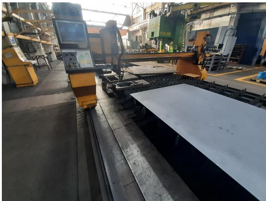
Slika 9. CNC stroj za plinsko rezanje "Ivana 30"
