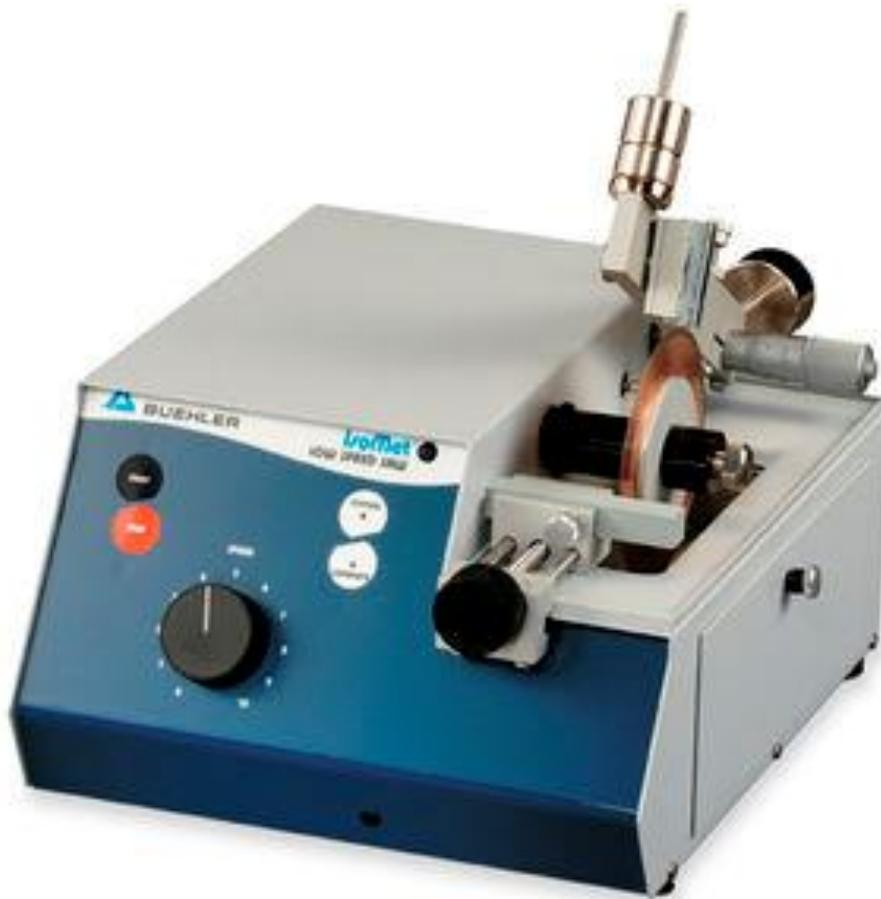
Slika 21. Uređaj za rezanje uzoraka za ispitivanje
