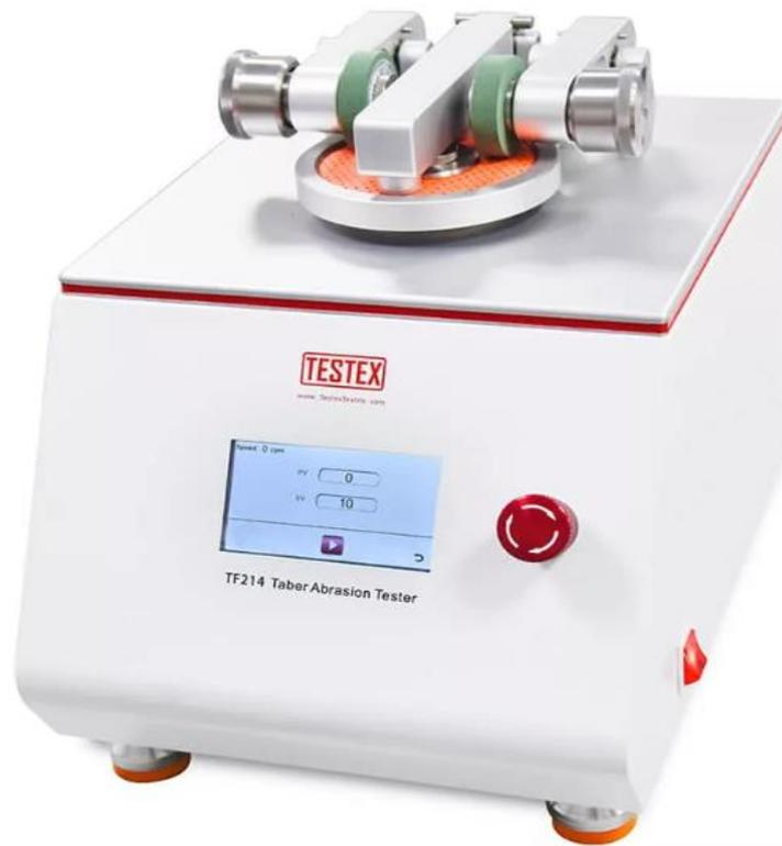
Slika 23. Uređaj za ispitivanje trošenja
