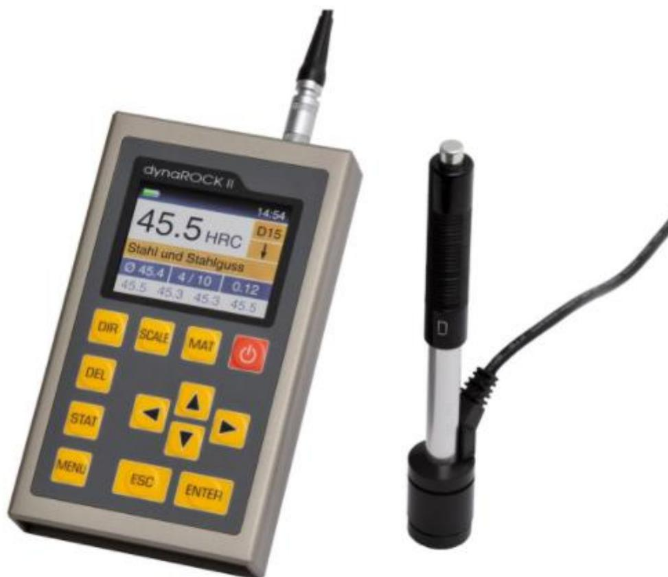
Slika 29. Uređaj za ispitivanje tvrdoće
