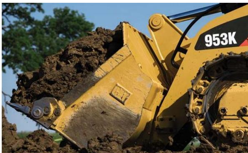
Slika 15. a Utovarivač prednja utovarna korpa
