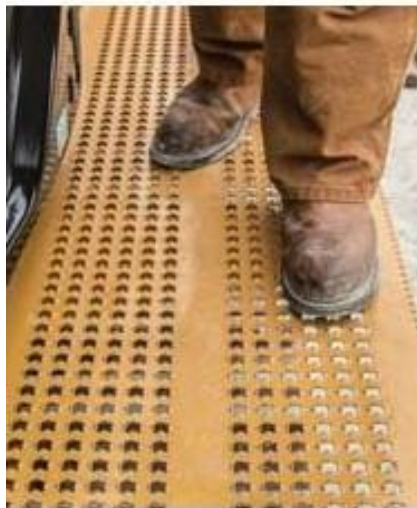
Slika 20. c Zaštitna naprava na velikom bageru protuklizna stepenica
