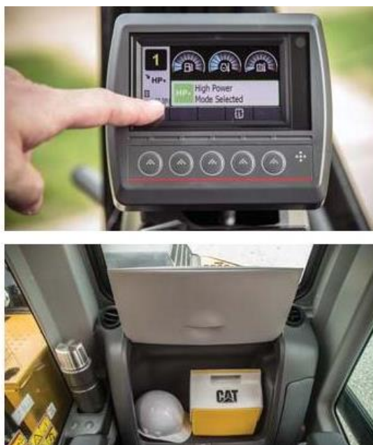
Slika 9. Unutrašnjost bagera unutarnji monitor i skladišni prostor
