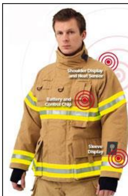
Sl. 23. Vatrogasna jakna s integriranom tehnologijom toplinskih senzora [24]
